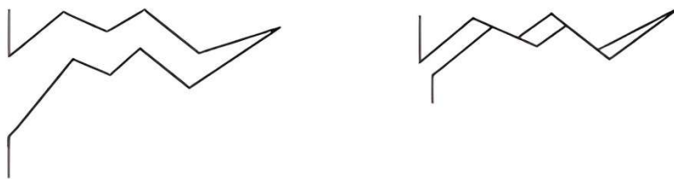
Figura 18. Cierre de grieta por rugosidad.
