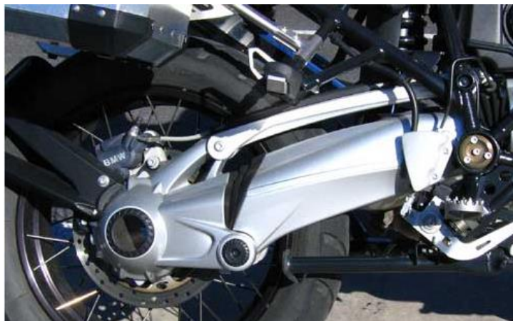
Figura 25: BMW R1200GS con pinza de freno atornillada a pivote. Fuente: [14]
