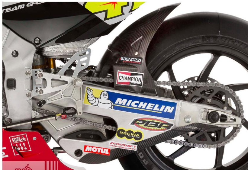
Figura 43: Basculante de una Aprilia RS-GP de 2017. [23]
