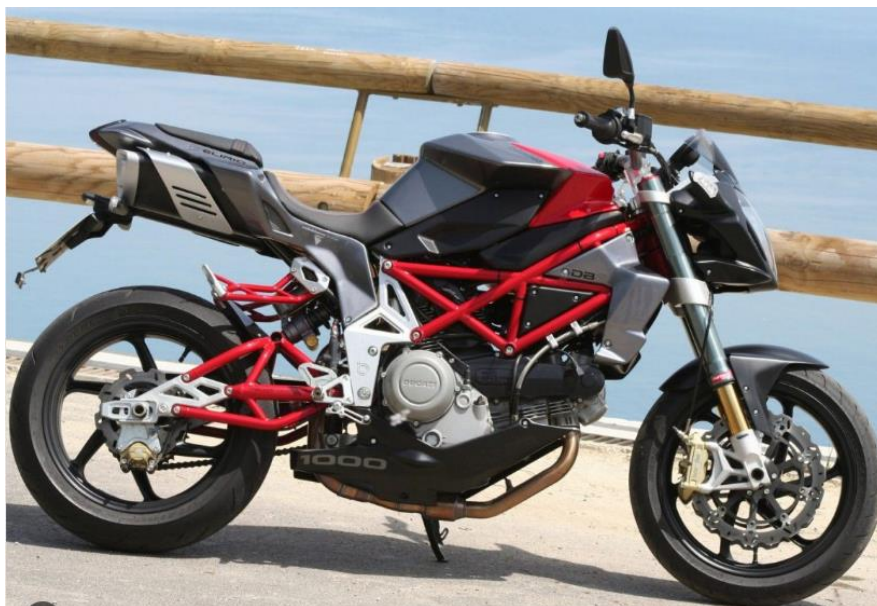
Figura 18: Basculante tubular de sección redonda de una Bimota Db6. [12]
