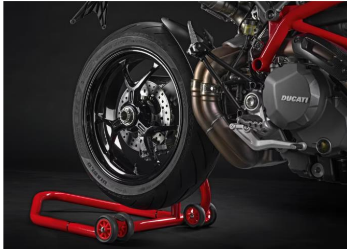
Figura 13: Vista de la rueda trasera con basculante monobrazo de una Ducati. [9]
