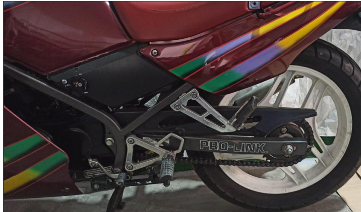
Figura 17: Basculante tubular de sección rectangular sin refuerzo de una Honda NSR 125 R. [2]
