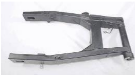
Figura 15: Basculante sin refuerzo. [33]
