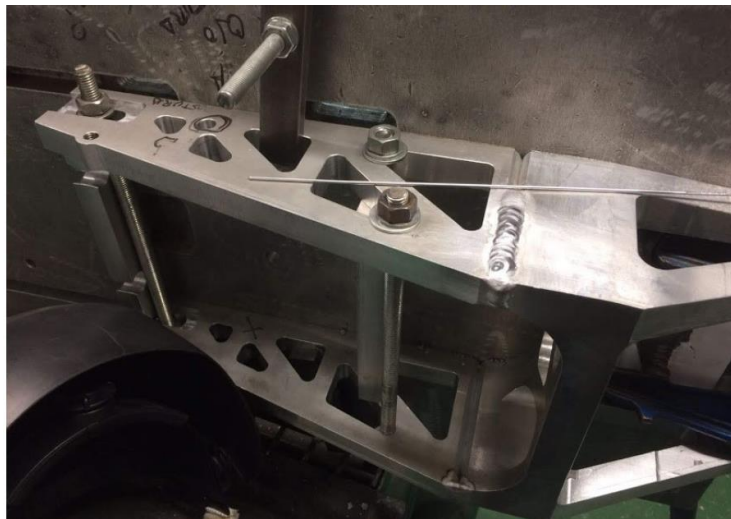
Figura 160: Proceso de soldadura del basculante de 2018. [2]
