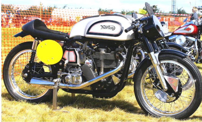
Figura 12: Sistema de doble suspensión de una Norton 500 Max. [8]
