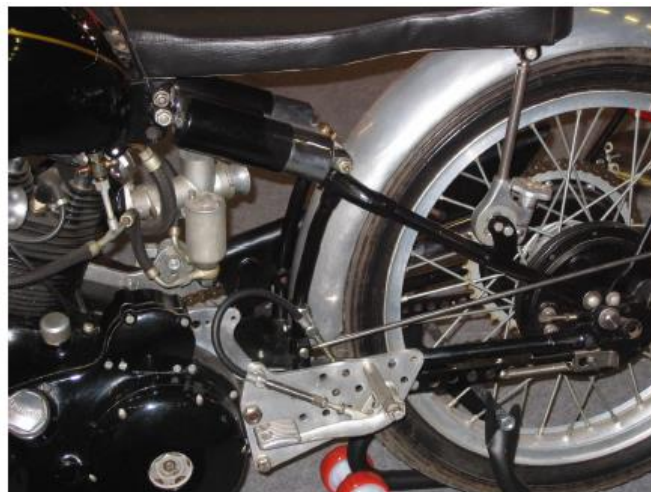
Figura 11: Suspensión tipo Cantilever, inventada por Vincent. [7]
