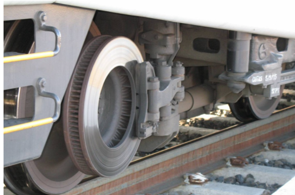
Figura 14: Discos de freno. Fuente: [34]
