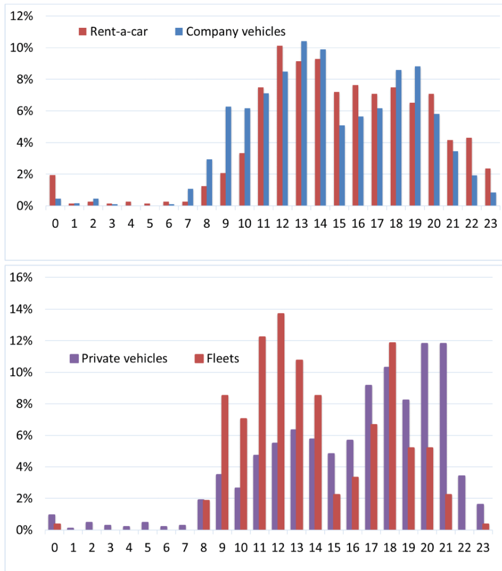
Figura 2.23. Porcentaje de la demanda diaria de energía, en cada hora a lo largo de un año, debida a la recarga convencional de vehículos eléctricos [29]
