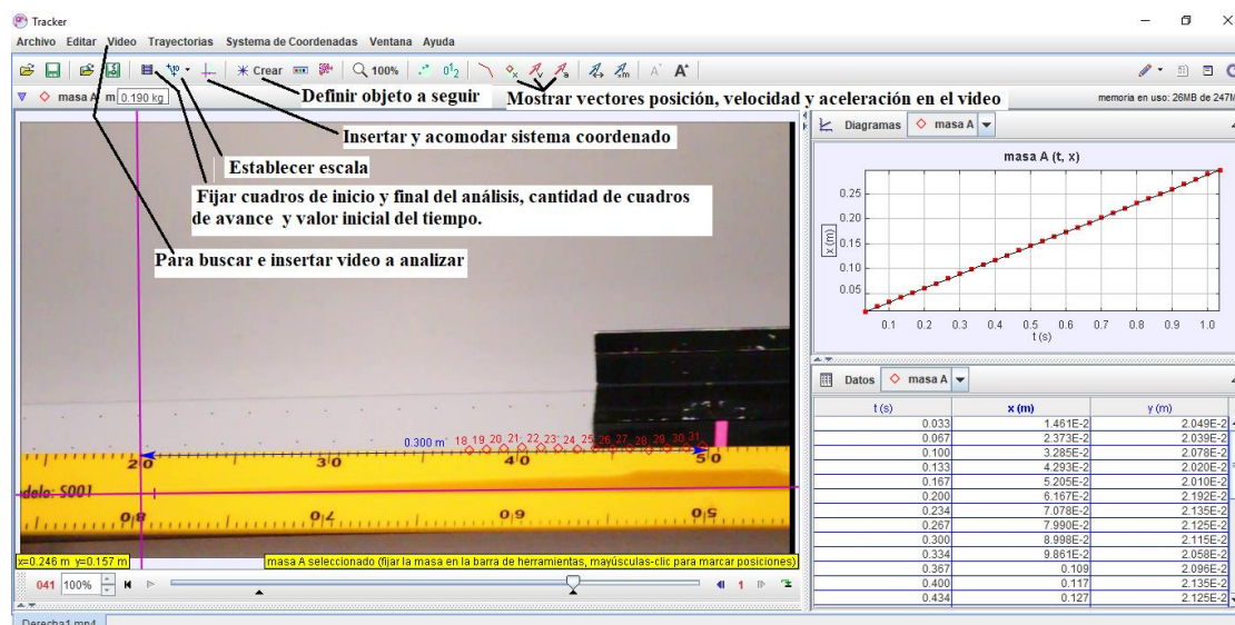
Figura 11. Imagen mostrando una pantalla del programa Tracker. Podemos observar las opciones que permiten ingresar un vídeo y comenzar a analizarlo.
