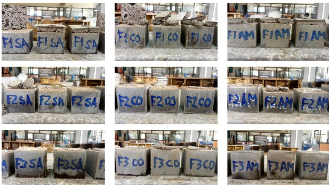
Figura 6.2. Probetas de los MEHs conformadas para los ensayos de esfuerzo de compresión.
