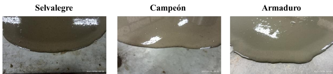
Figura 5.11. Ensayos de minicono de MEH F3 seleccionados. Arena BS. aa/cc = 0,30 . 2,0 % ca Viscocrete.
