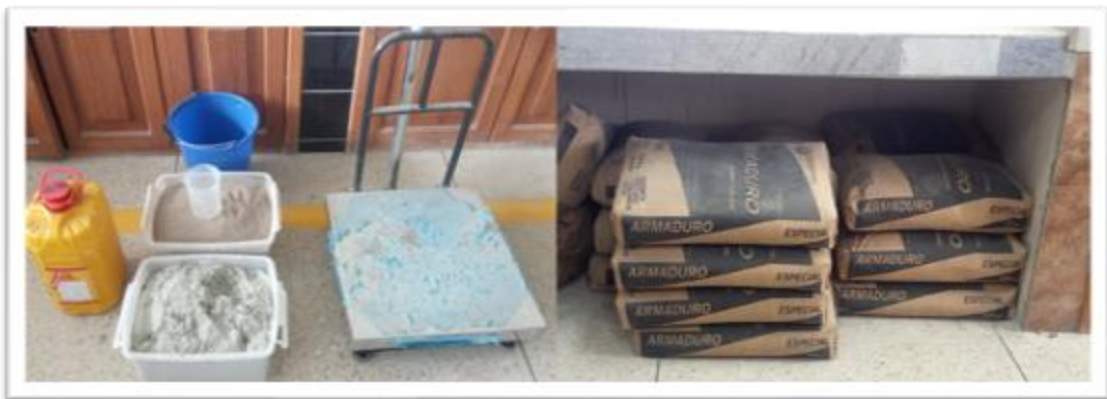
Figura 3.4. Materiales para preparar HAC a gran escala: aditivo Sika, agregados finos, cemento, contenedor para las mezclas y báscula de pedestal.
