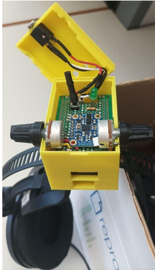
Figura 4.5. Hardware y encapsulado final donde se ejecuta la aplicación.
