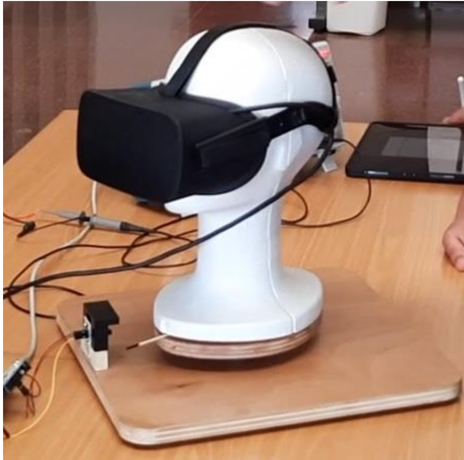
Figura 1.2. Uso de un casco de VR para procesado de audio con 3DTI Toolkit. Sistema de medida de latencia.
