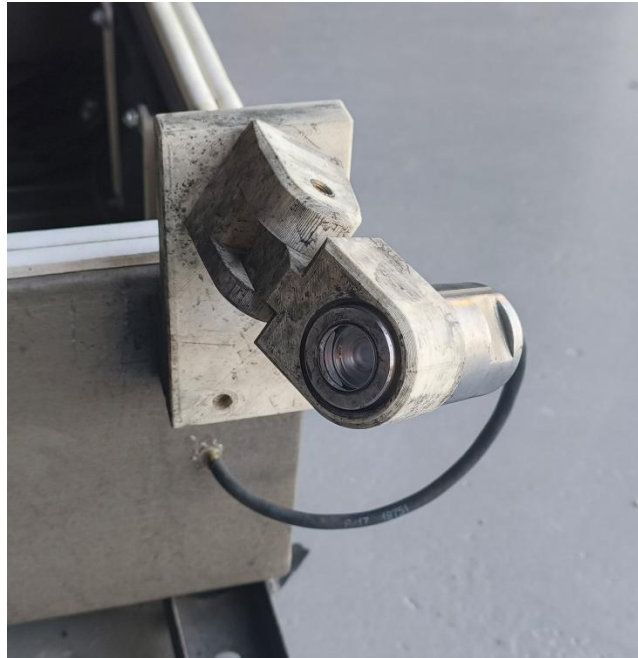
Figura 5. Sensor de arco eléctrico UV de la marca sglux utilizado en el dispositivo
