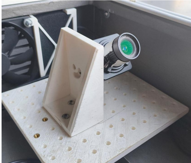
Figura 6. Cámara HD de la marca Arducam utilizada en el dispositivo
