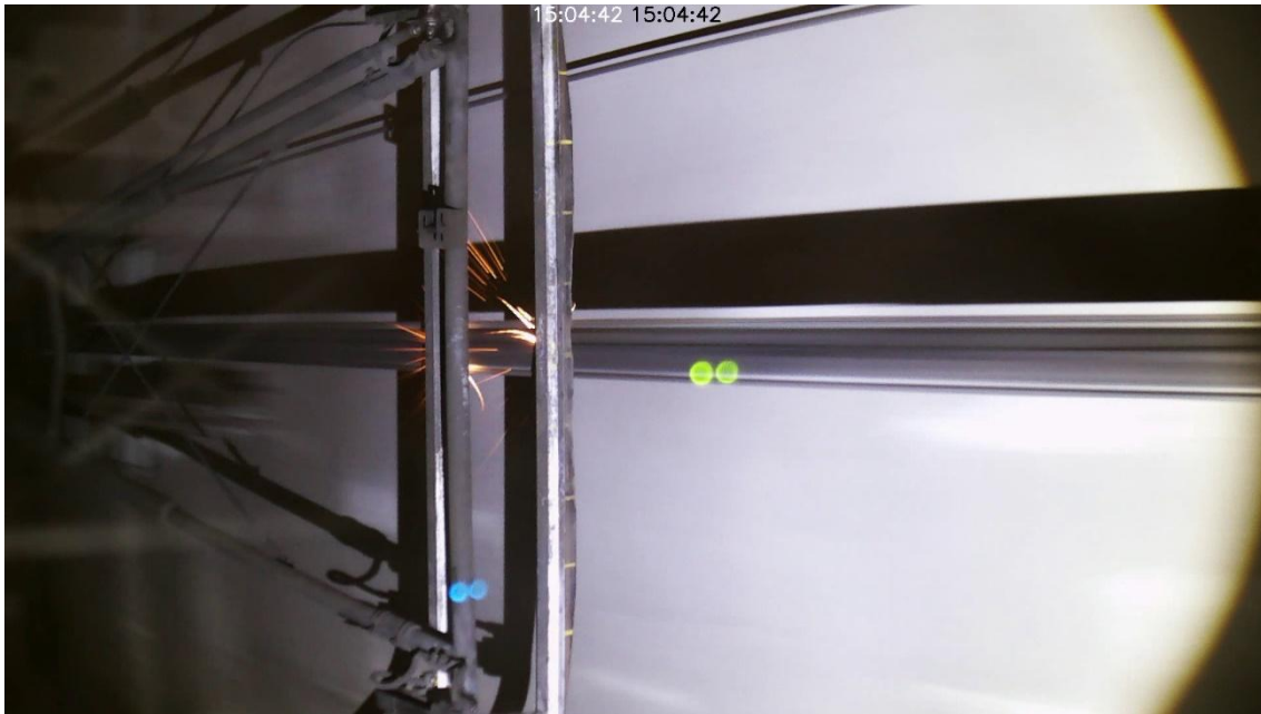
Figura 26. Muestra de arco eléctrico capturado por la cámara
