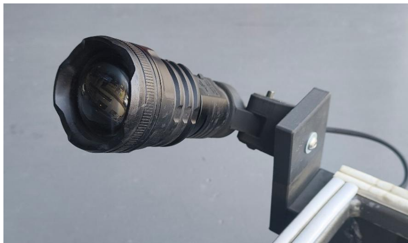
Figura 7. Linterna incorporada al dispositivo para mejorar la visibilidad
