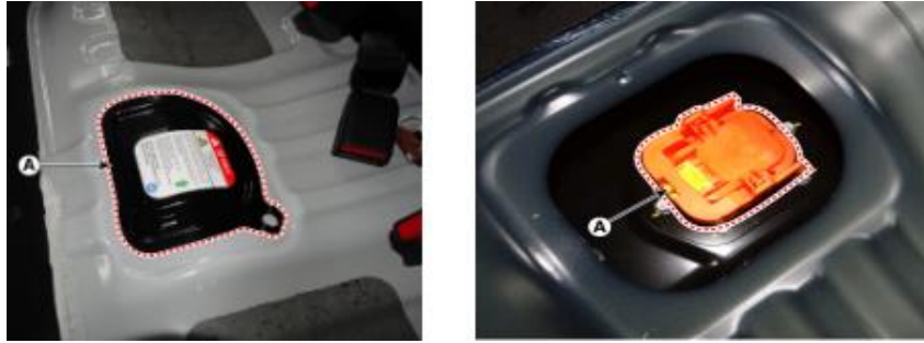
Ilustración 45. Tapa de servicio y conector de alto voltaje
