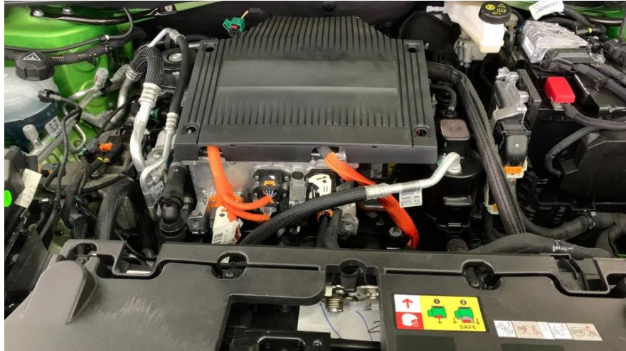
Ilustración 52. Cableado de alto voltaje Opel Mokka
