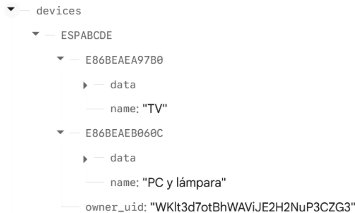
Fig. 19. Estructura jerárquica de un ESP32 con dos enchufes asociados.
