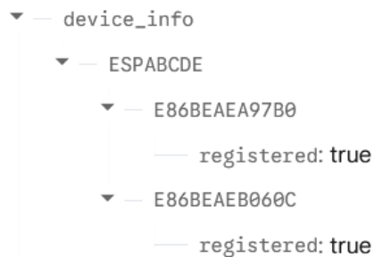
Fig. 20. Estructura jerárquica de la colección device_info .
