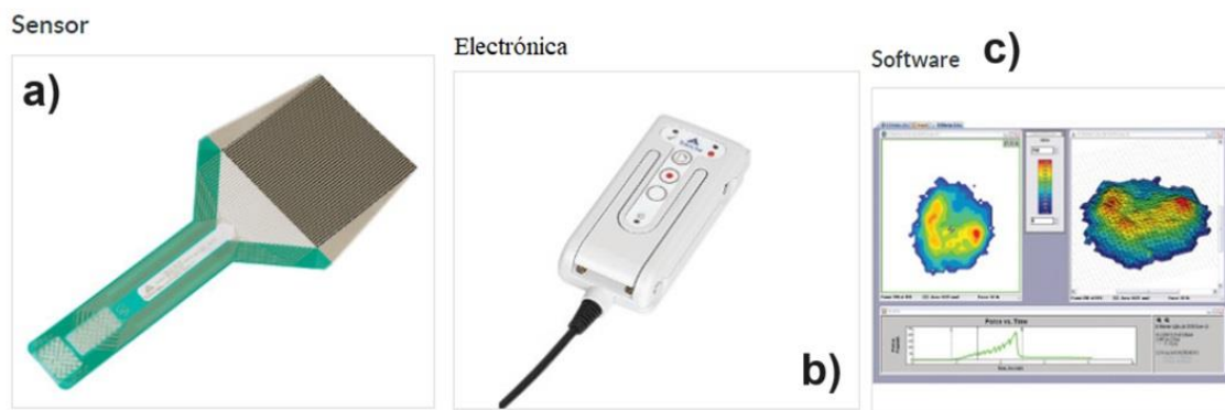
Figura 28. a) Sensor. b) Electrónica. c) Software del sistema I-Scan.
