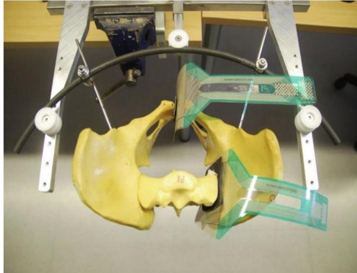
Figura 27. Construcción de fijación que muestra el tensor deformando la barra de fibra de carbono. Antes, se libera la tensión previa, los sensores Tekscan se colocan en las juntas rotas entre finas almohadillas elásticas [33].
