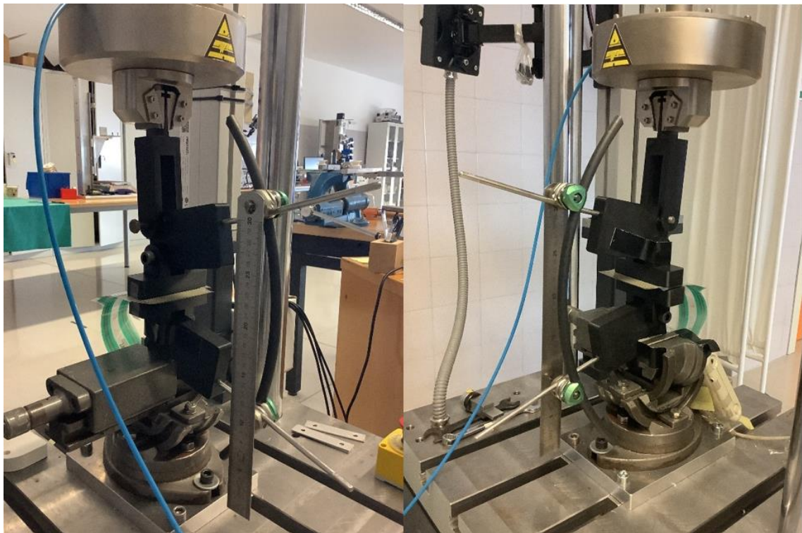
Figura 50. Fijador externo pretensado con pelvis simplificada colocado en la máquina de ensayos.
