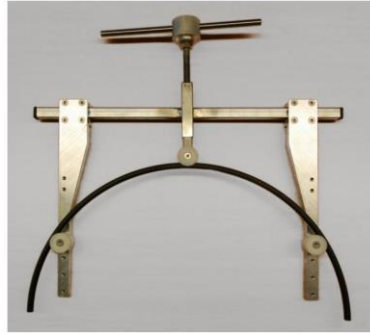
Figura 25. Tensor utilizado para aplicar pretensión a la varilla: La barra curva permanece en dos puntos laterales ubicados simétricamente mientras que el punto central se desplaza, empujado por actuador de tornillo [33].
