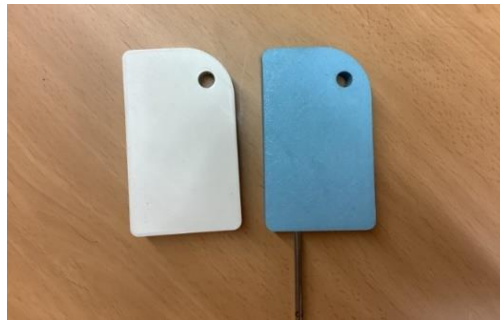
Figura 48. Pelvis simplificada con orificio para Clavos de Schanz \varnothing 5.00 mm.
