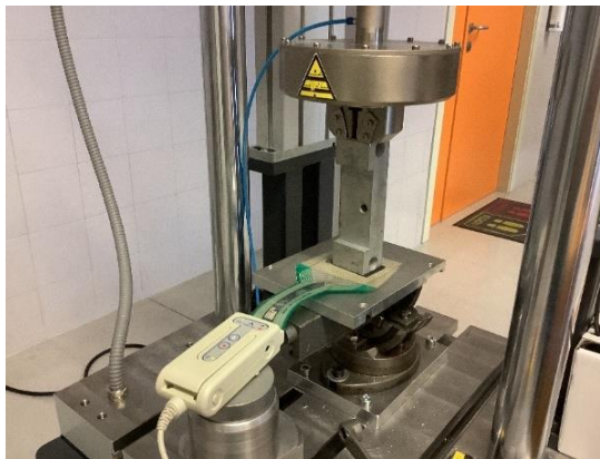
Figura 29. Sensor I-Scan sometido a una carga con Máquina de ensayos Ibertest.
