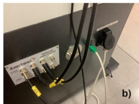
Figura 33. a) Módulo MD2i, en caja de seguridad, para integrar en el bastidor o en el cuadro eléctrico de la máquina de ensayos. b) Señales analógicas del sistema de control.
