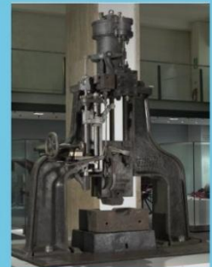
Modelo del martillo de vapor de Nasmyth conservado en "Science Museum", Londres
