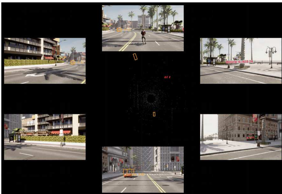
Figura 5.12: Detección de coches y bicis (ii) en AdverseOp3D.
