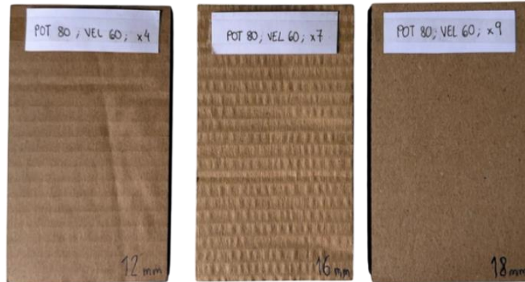
Figura 56. Parámetros de corte para distintos espesores || Fuente: Elaboración propia
