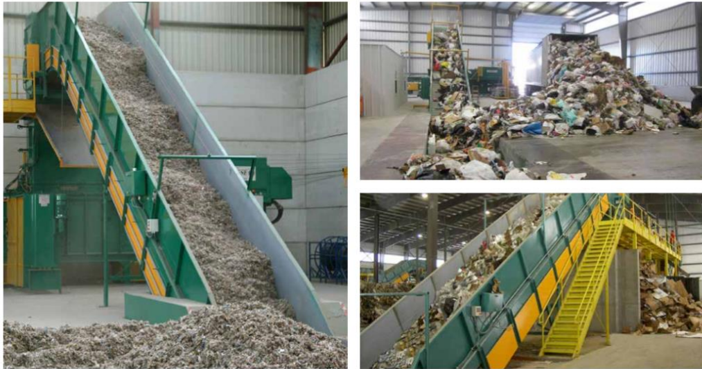
Imagen 6. Cinta transportadora de RSU. Fuente: macpresse.com
