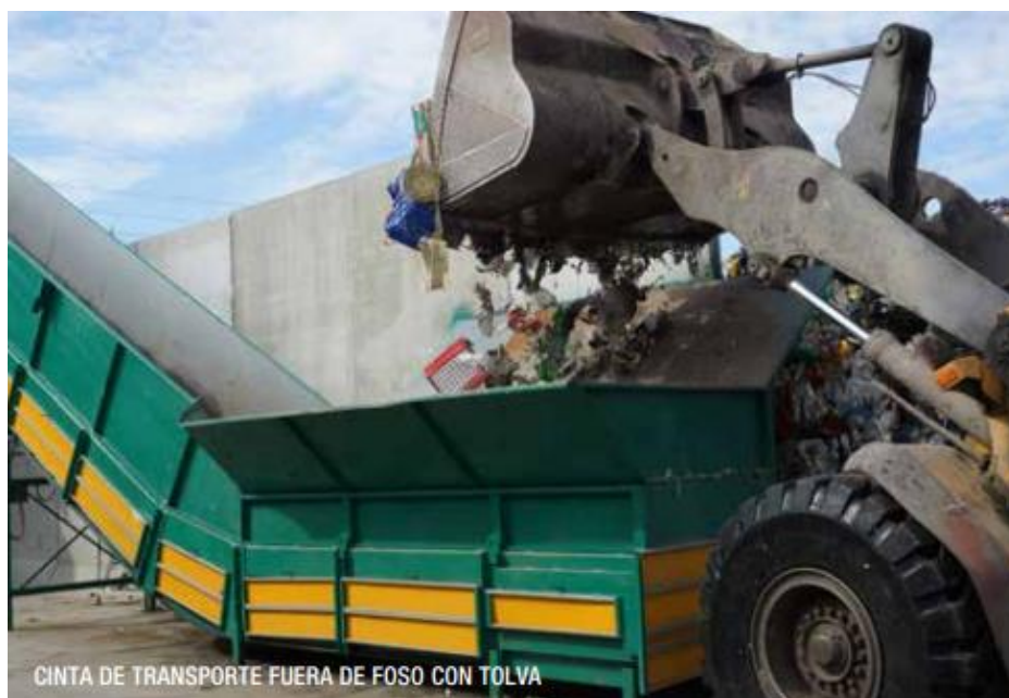
Imagen 7. Cinta de transporte fuera de foso con tolva. Fuente: macpresse.com
