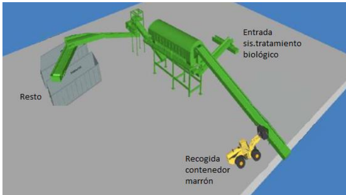
Imagen 10. Renderizado disposición pretratamiento de residuos. Fuente: LIMASAN
