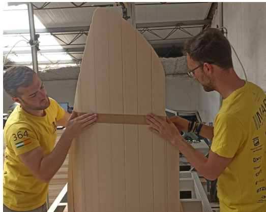
Ilustración 35. Resultado de uno de los cortes realizados en los moldes para el bodywork.
