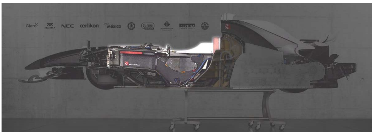
Ilustración 3. Cockpit de un F1 Sauber cortado longitudinalmente.
