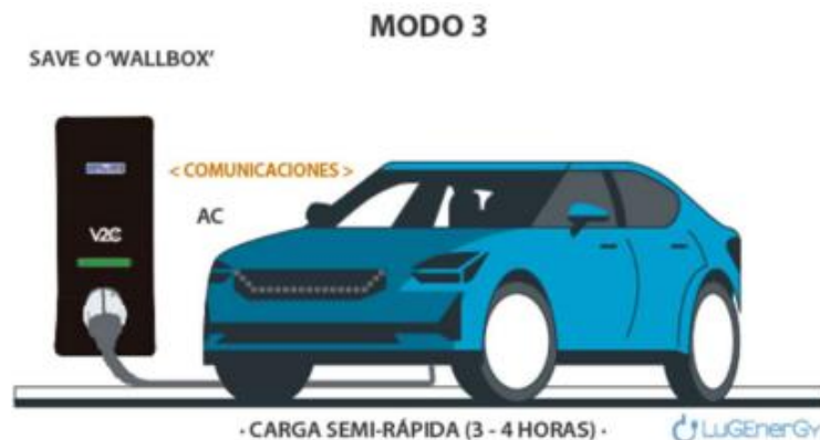
Figura 14. Modo de recarga 3 o Carga Semi-Rápida [13].
