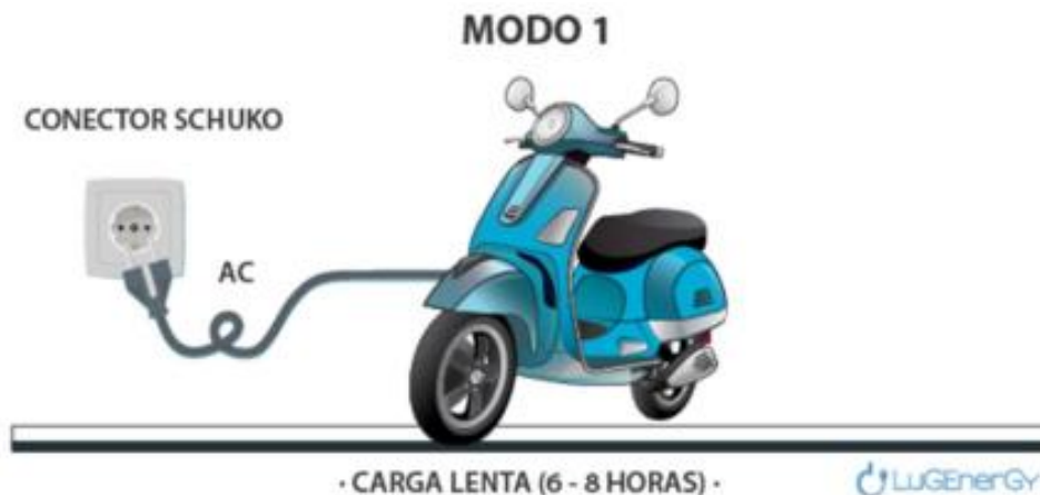
Figura 12. Modo de recarga 1 o Schuko [13].
