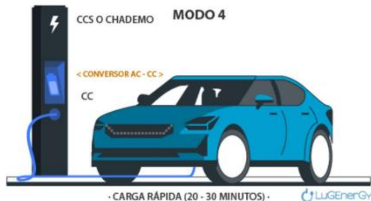
Figura 15. Modo de recarga 4 o Carga Rápida [13].
