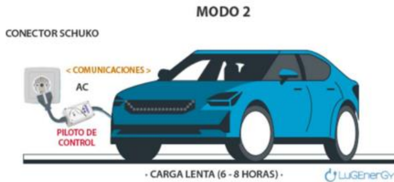
Figura 13. Modo de recarga 2 o Carga Lenta [13].
