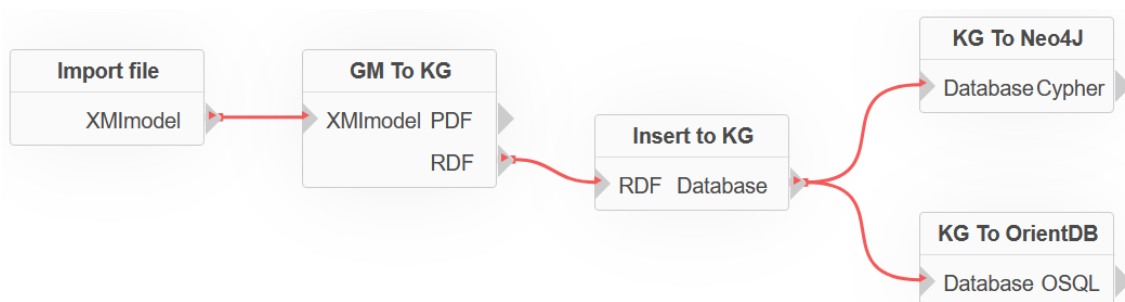
Figura 5.5: Flujo de trabajo que dado un metamodelo de una base de datos, genera la implementación final en diferentes sistemas de gestión de bases de datos.
