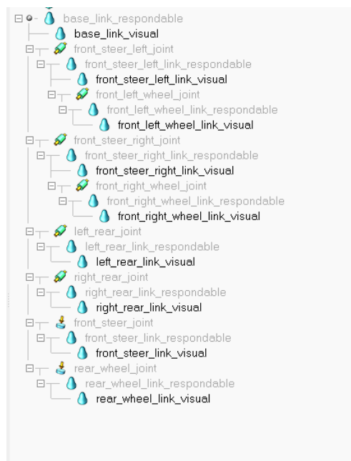
Figura 21. Estructura del modelo URDF del robot, CoppeliaRobotics.
