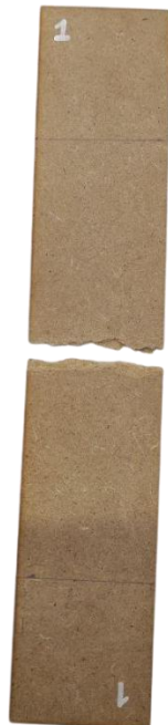
Figura 110. Fotografías del modo de fallo en las seis probetas sin tras el ensayo de flexión. Fuente: Elaboración propia
