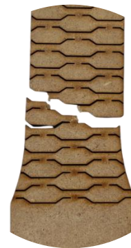
Figura AX8. Fractura observada en Probeta 1B (patrón B) tras el ensayo de tracción
