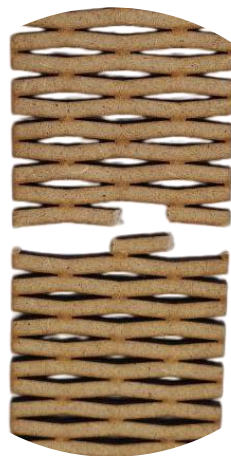
Figura AX26. Fractura observada en Probeta 1 (patrón C) tras el ensayo de flexión
