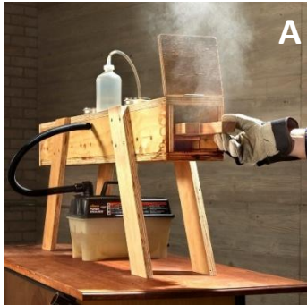
Curvado en caliente (vapor) Fuente: www.familyhandyman.com
