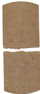
Figura AX18. Fractura observada en Probeta 5 (sin patrón) tras el ensayo de flexión
