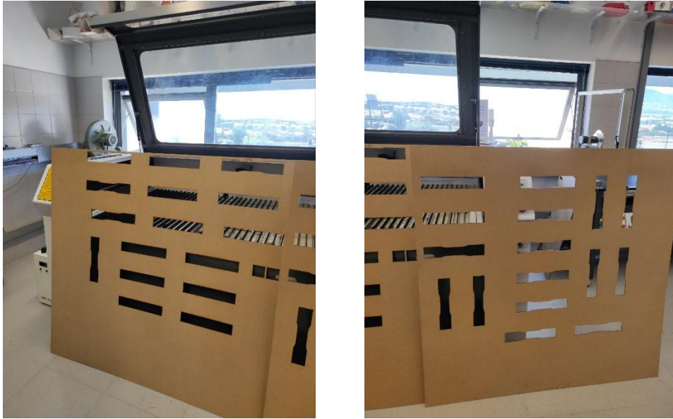
Figura 61. Despiece realizado con la cortadora láser
