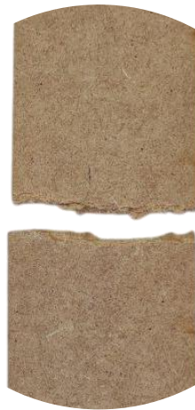
Figura AX16. Fractura observada en Probeta 3 (sin patrón) tras el ensayo de flexión
