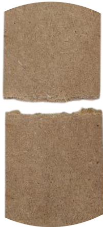
Figura AX15. Fractura observada en Probeta 2 (sin patrón) tras el ensayo de flexión
