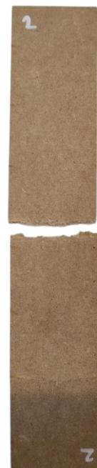
Figura 110. Fotografías del modo de fallo en las seis probetas sin tras el ensayo de flexión. Fuente: Elaboración propia
