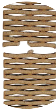
Figura AX28. Fractura observada en Probeta 3 (patrón C) tras el ensayo de flexión
