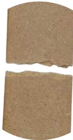
Figura AX14. Fractura observada en Probeta 1 (sin patrón) tras el ensayo de flexión
