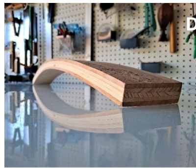
Resultado del método de laminación Fuente: www.tomraffield.com
