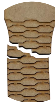
Figura AX10. Fractura observada en Probeta 3B tras el ensayo de tracción
