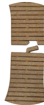
Figura AX5. Fractura observada en Probeta 1A (patrón A) tras el ensayo de tracción
