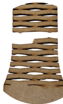
Figura AX13. Fractura observada en Probeta 3C tras el ensayo de tracción
