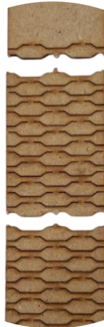
Figura AX25. Fractura observada en Probeta 3 (patrón B) tras el ensayo de flexión
