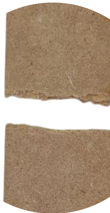
Figura AX17. Fractura observada en Probeta 4 (sin patrón) tras el ensayo de flexión
