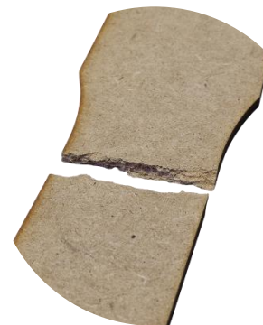
Figura AX2. Fractura observada en Probeta 2 (sin patrón) tras el ensayo de tracción
