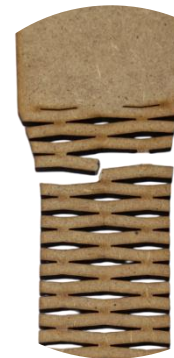
Figura AX12. Fractura observada en Probeta 2C tras el ensayo de tracción
