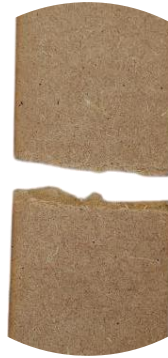
Figura AX19. Fractura observada en Probeta 6 (sin patrón) tras el ensayo de flexión
