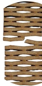
Figura AX11. Fractura observada en Probeta 3B tras el ensayo de tracción
