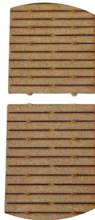
Figura AX22. Fractura observada en Probeta 3 (patrón A) tras el ensayo de flexión
