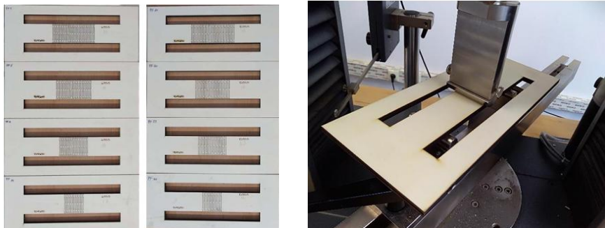
Figura 21. Probetas enmarcadas y test de flexión por Condoroțeanu et al. (2022)
