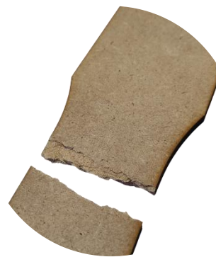
Figura AX1. Fractura observada en Probeta 1 (sin patrón) tras el ensayo de tracción
