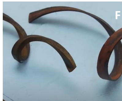
Resultados empleando el curvado con amoniaco Fuente: Applied Science
