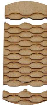
Figura AX24. Fractura observada en Probeta 2 (patrón B) tras el ensayo de flexión
