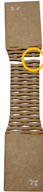
Figura 102. Fotografías del modo de fallo en las tres probetas con patrón C tras el ensayo de tracción. Fuente: Elaboración propia
