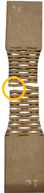
Figura 102. Fotografías del modo de fallo en las tres probetas con patrón C tras el ensayo de tracción. Fuente: Elaboración propia
