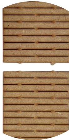
Figura AX21. Fractura observada en Probeta 2 (patrón A) tras el ensayo de flexión
