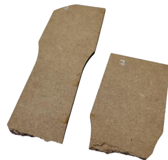
Figura AX4. Fractura observada en Probeta 4 (sin patrón) tras el ensayo de tracción
