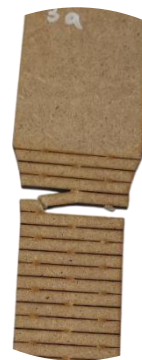
Figura AX7. Fractura observada en Probeta 3A (patrón A) tras el ensayo de tracción
