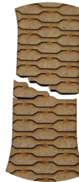
Figura AX9. Fractura observada en Probeta 2B tras el ensayo de tracción
