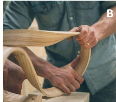
Resultado del curvado en caliente Fuente: www.tomraffield.com
