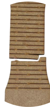
Figura AX6. Fractura observada en Probeta 2A (patrón A) tras el ensayo de tracción
