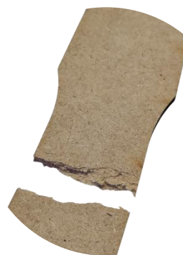
Figura AX3. Fractura observada en Probeta 3 (sin patrón) tras el ensayo de tracción
