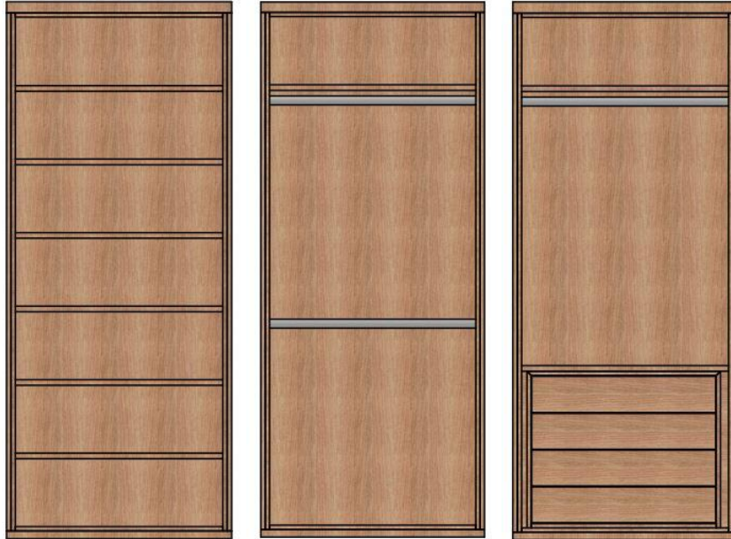
Ilustración 5. Armario con baldas, armario con barras y armario con cajonera. Fuente: Elaboración propia.
