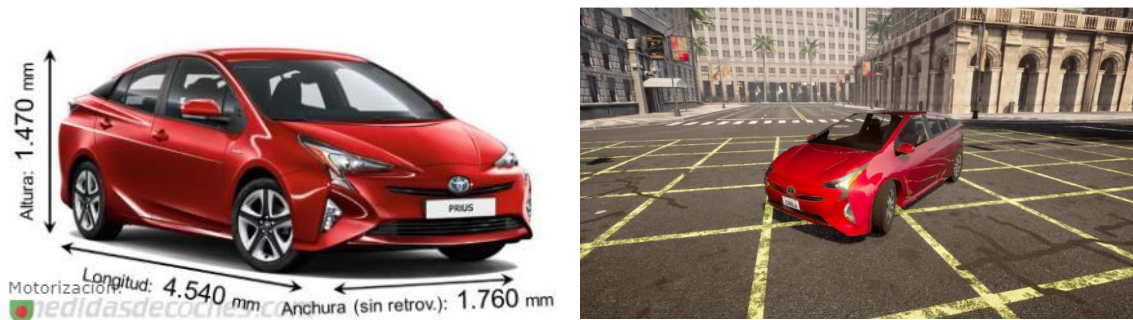
Figura 3.11. Comparación visual entre el modelo real del Toyota Prius y el de CARLA [22] [23]
