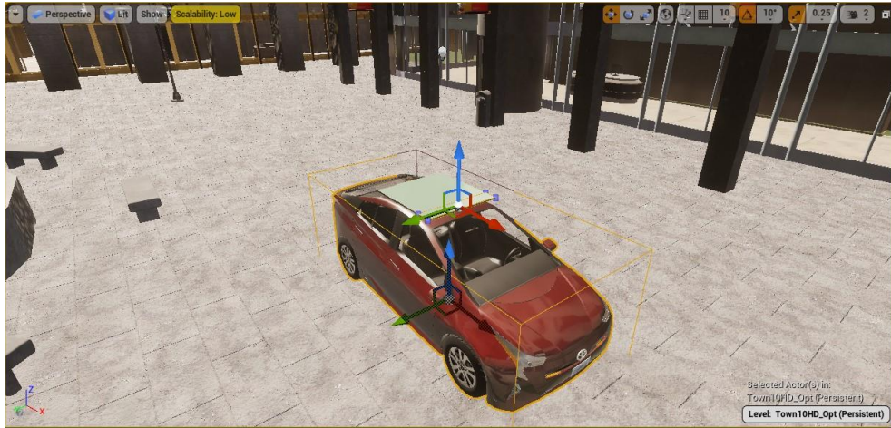
Figura 3.12. Sistema de referencia de la plataforma de sensores
