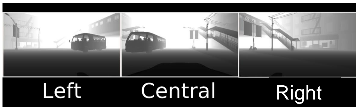
Figura 4.11. Vista del autobús con las cámaras ZED2i modeladas (profundidad)
