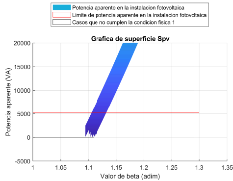
Figura 3.21: Perfil de la gráfica de superficie S_{pv} con límite de 5 kW.
