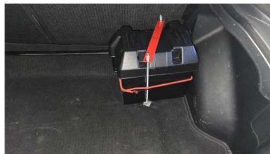
Figura 28: Caja estanca homologada para baterías
