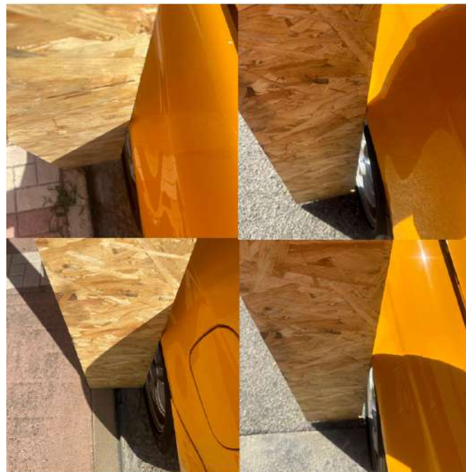
Figura 24: Comprobación Directiva 78/549/CEE, de recubrimiento de ruedas (Neumático no sobresale de aleta)
