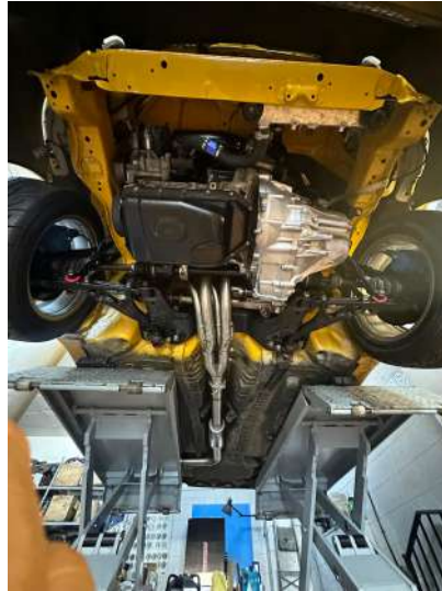
Figura 12: Línea de escape, vista inferior
