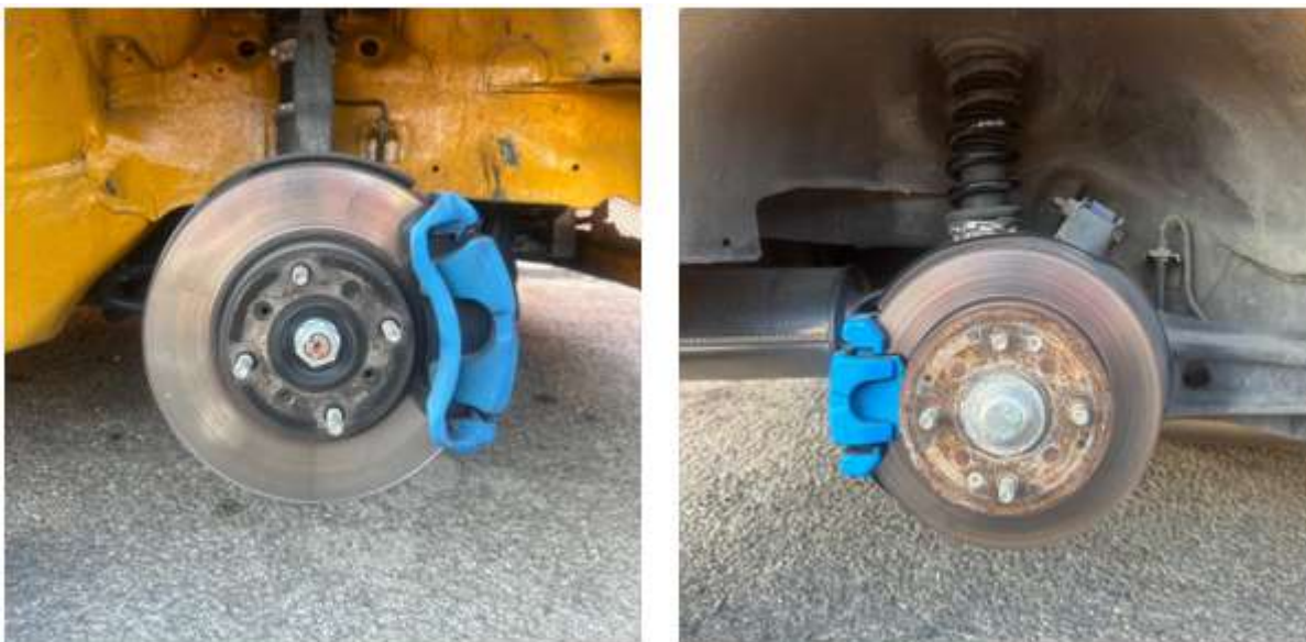
Figura 15: Nueva frenada. Eje delantero 282 mm/ Eje trasero 262 mm
