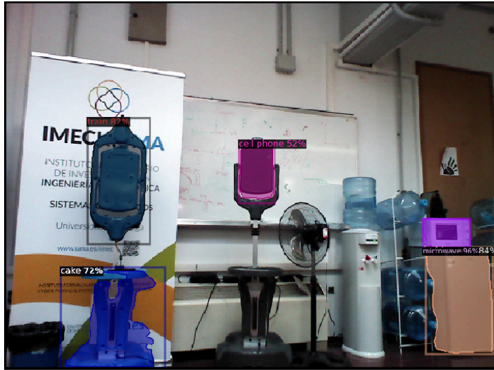
Figure 2: Ejemplo ilustrativo del rendimiento reducido de la red de detección de objetos Detectron2 [8] en una imagen que contiene objetos cuyas categorías no fueron consideradas en el entrenamiento. Los resultados demuestran que la red detecta correctamente objetos de estas categorías, como el frigorífico (84%) y el microondas (96%). Sin embargo, produce clasificaciones excesivamente seguras pero incorrectas cuando encuentra objetos que no estaban en el conjunto de entrenamiento, como robots móviles, etiquetándolos como un pastel (72%), un tren (82%) y un teléfono móvil (52%).
