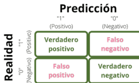
Figura 2.14: Representación de la matriz de confusión y sus detalles. Imagen extraída de impulsatek 9
