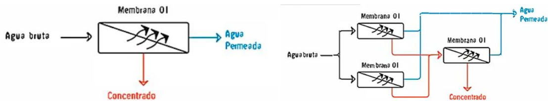
Figuras 28 y 29. Izquierda, ósmosis inversa de 1 etapa; derecha, ósmosis inversa de 2 etapas
