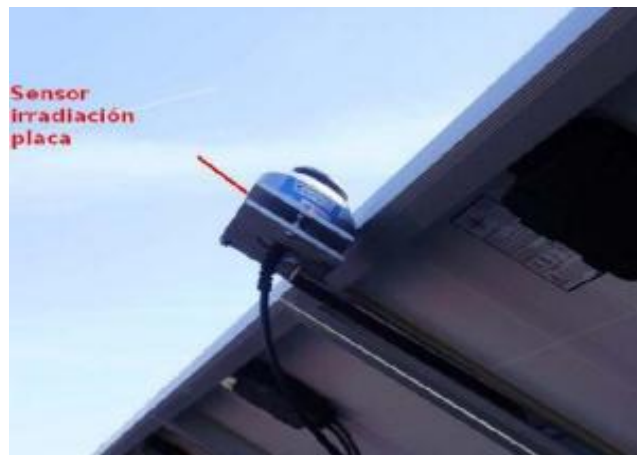
Figura 32. Piranómetro para medir la radiación en una placa solar inclinada.
