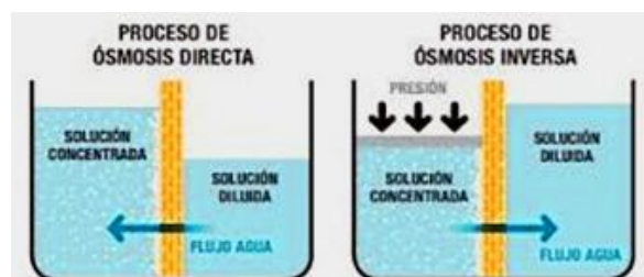
Figura 26. Comparación ósmosis directa e inversa
