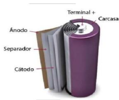
Figuras 41 y 42. A la izquierda, batería de plomo-ácido. A la derecha, batería de ion-litio.
