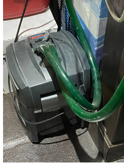
Figura 3.13: Bomba de agua utilizada.
