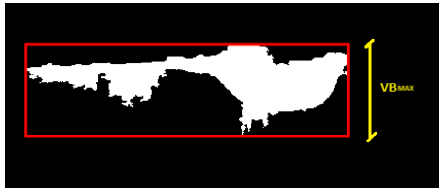
Figura 6.7 - Obtención de la altura de desgaste de incidencia ( VB_{MAX} ) a partir de su "Bounding Box".
