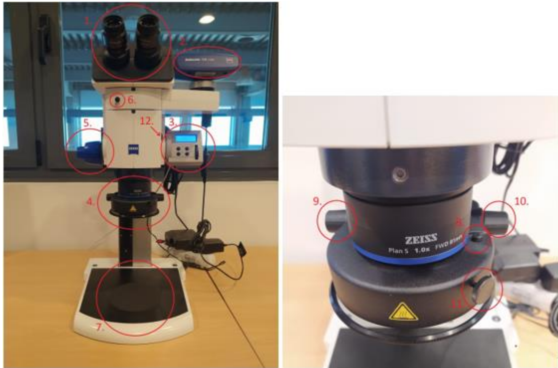
Figura 5.6 - Imagen del microscopio ZEISS Discovery 12 con las partes a destacar señalizadas.
