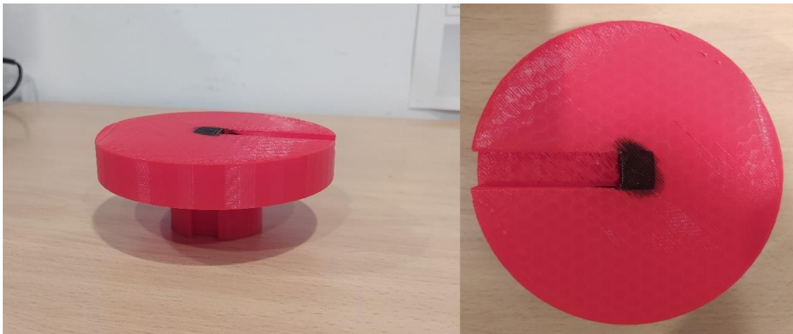
Figura 5.11 - Imágenes de la cabeza del soporte del microscopio (cara de desprendimiento) procesado por fabricación aditiva.
