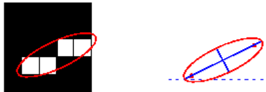
Figura 5.40 - Representación de los ejes mayores y menores en una acumulación de píxeles.
