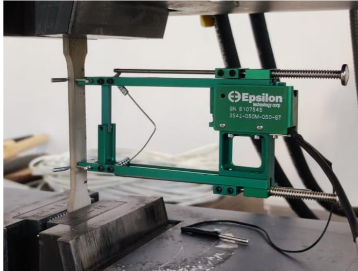
Figura 26.- Extensómetro axial modelo 3452 utilizado [Fuente propia]
