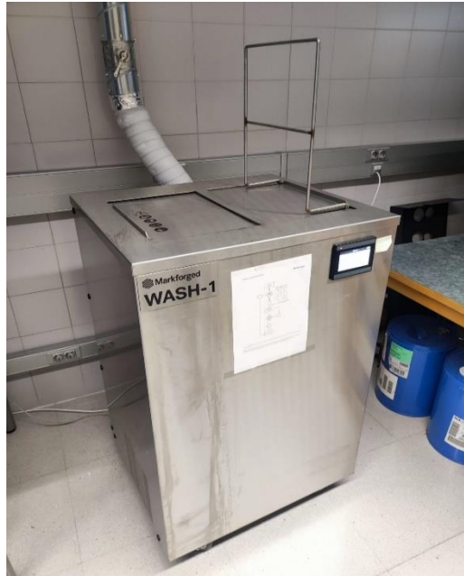
Figura 4.- Estación de lavado Wash-1 [Fuente propia]
