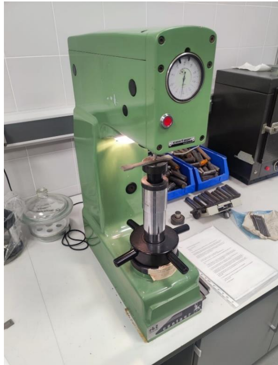
Figura 8.- Durómetro Centaur RB2 utilizado para los ensayos de dureza [Fuente propia]
