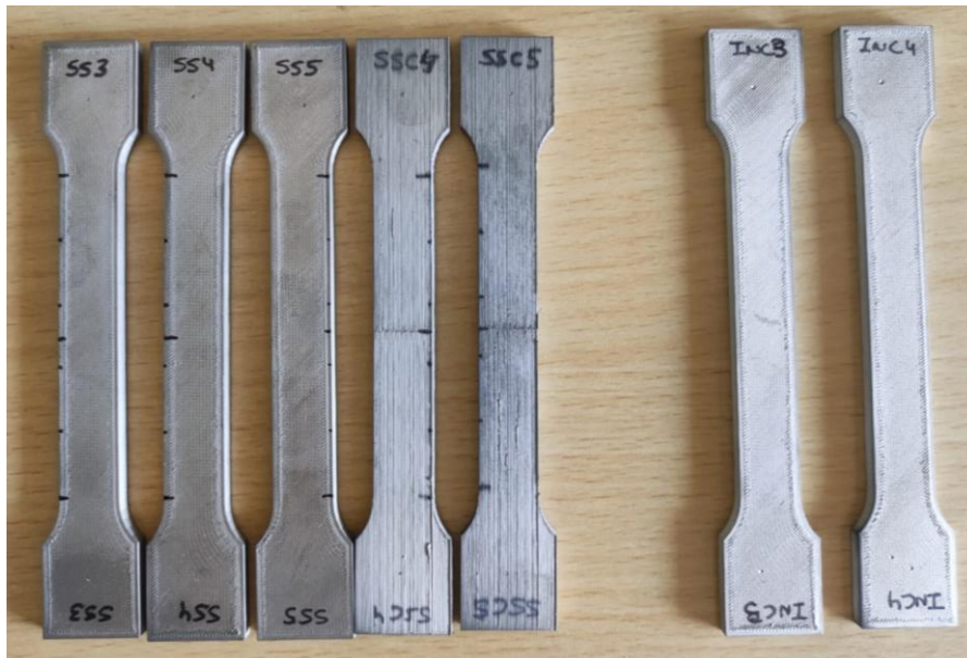
Figura 24.- Ejemplos de codificación de algunas de las probetas fabricadas [Fuente propia]
