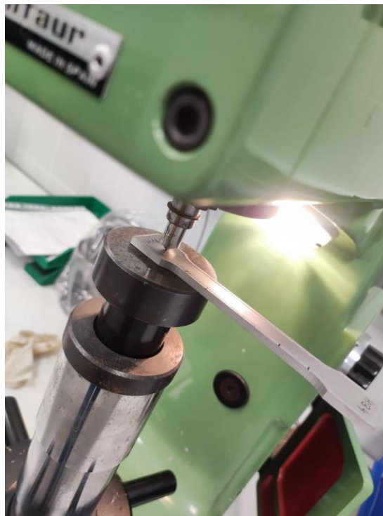
Figura 9.- Colocación de la probeta en el durómetro [Fuente propia]
