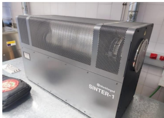
Figura 5.- Horno de sinterizado Sinter-1 [Fuente propia]
