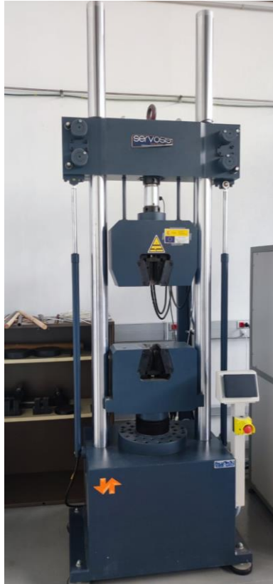
Figura 25.- Máquina de ensayos Servosis MUE 403/65 [Fuente propia]
