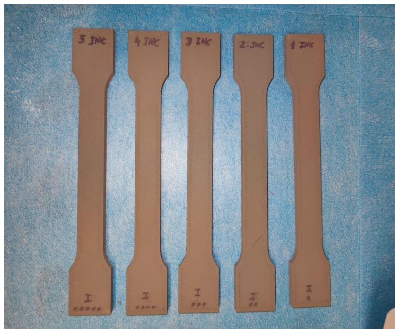
Figura 20.- Muestra de algunas de las probetas "verdes" recién impresas [Fuente propia].
