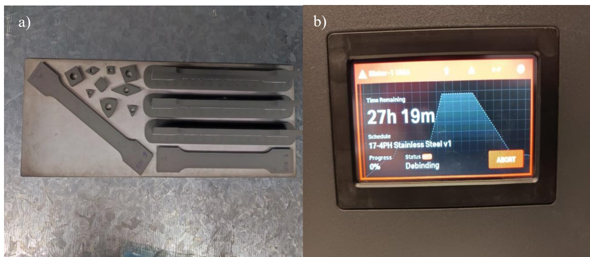
Figura 22.- a) Colocación de las probetas para su introducción en Sinter-1 y b) Pantalla de control del horno de sinterizado [Fuente propia]
