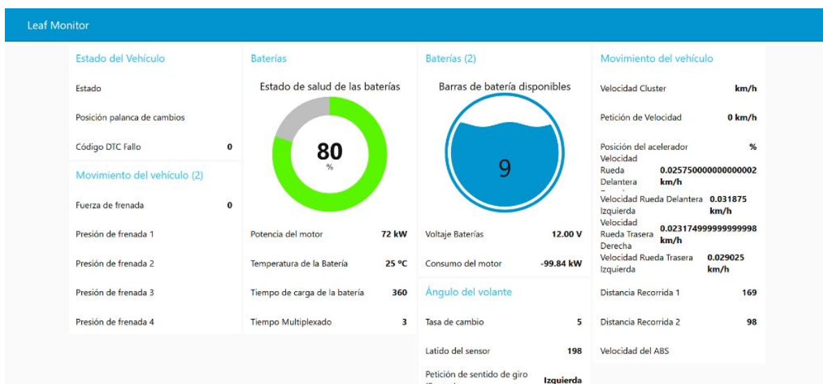
Figura 6.2: Captura del dashboard de Node-RED recibiendo y representando datos en tiempo real.
