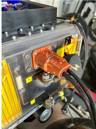
Figura 2. Conexión de la potencia del cargador con la motocicleta.
