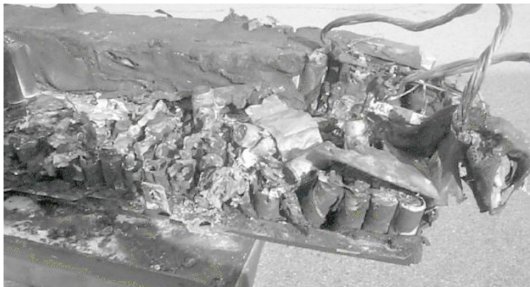
Figura 5. Paquete de baterías de litio de un coche eléctrico tras incendiarse. Fuente: Andrea (2010) [4].
