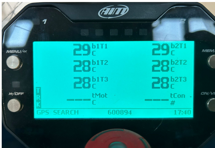
Figura 3. Visualización de la temperatura al inicio del uso.
