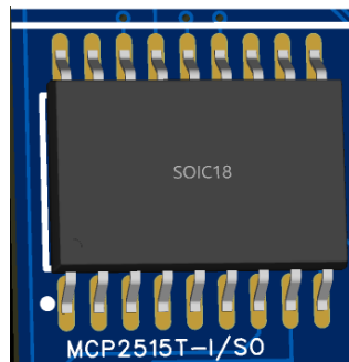
Figura 3. Modelo 3D de MCP2515T en el hardware del BMS.
