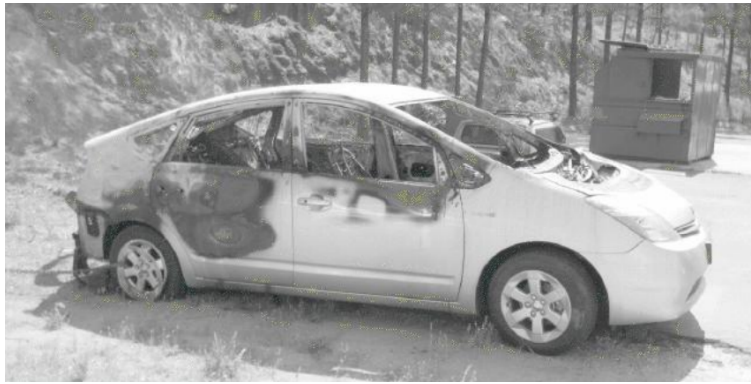
Figura 4. Coche eléctrico tras incendio del paquete de baterías. Fuente: Andrea (2010) [4].
