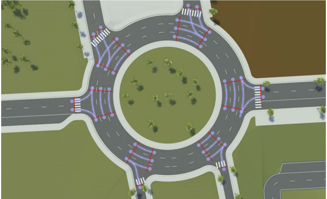
Figura 39. Salidas e incorporaciones de la rotonda norte que une la Escuela de Ingenierías y la Facultad de Estudios Sociales y del trabajo
