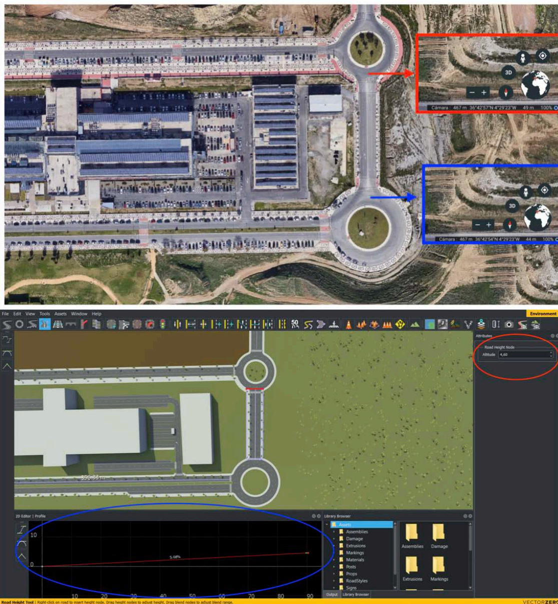
Figura 33. Comparación de la altitud de la carretera este de la Escuela de Ingenierías. Medida de Google Earth arriba y medida en RoadRunner abajo.
