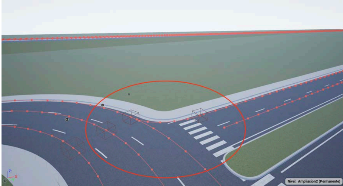
Figura 43. Ruta incompleta en la incorporación a una rotonda
