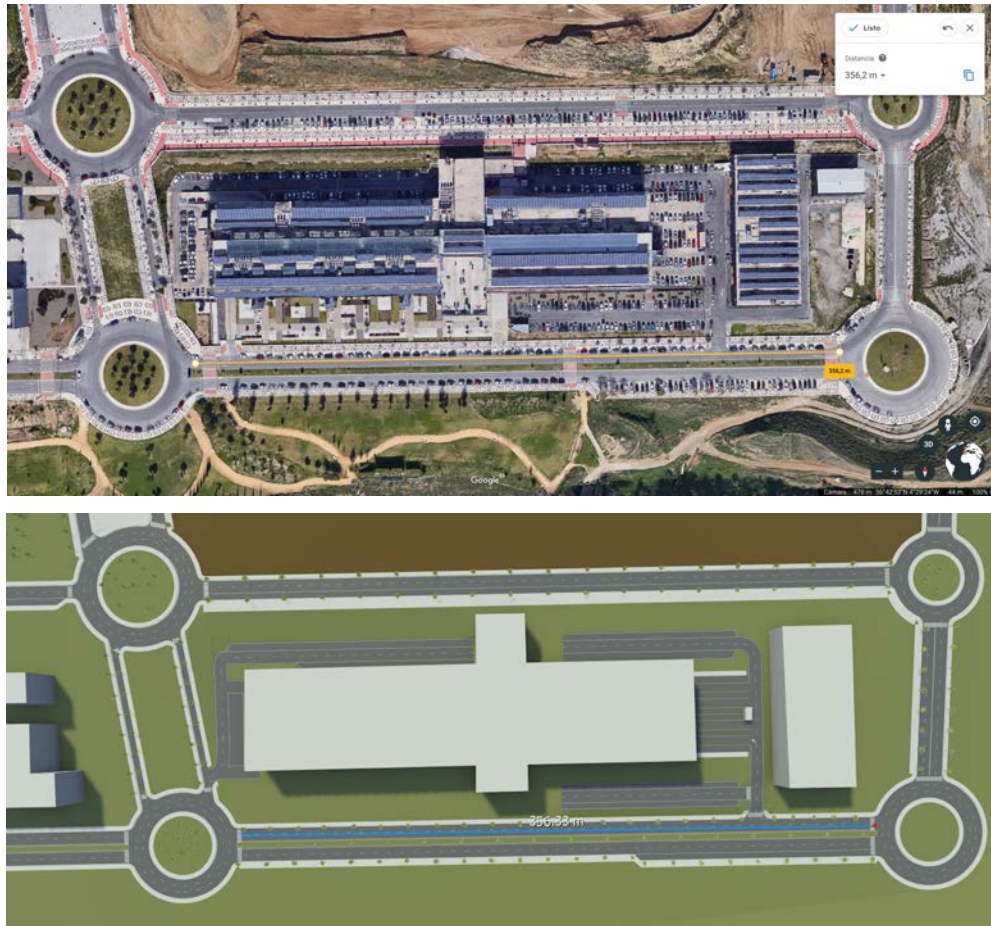
Figura 32. Comparación de la longitud de la carretera delantera de la Escuela de Ingenierías. Medida de Google Earth arriba y medida en RoadRunner abajo.
