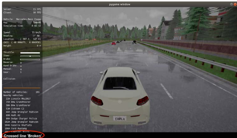
Figura 16. Sensor de invasión de línea
