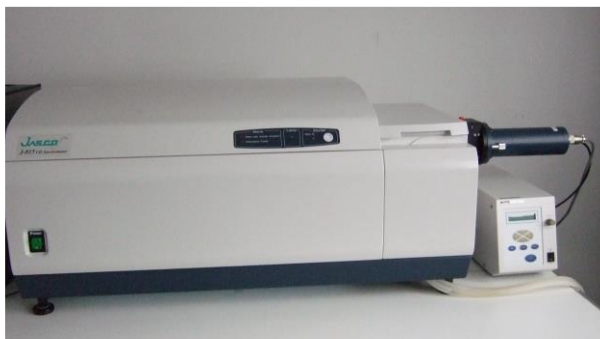
Figura 3-3. Espectrómetro CD J-815 y el controlador de temperatura y agitación de la cubeta de la muestra a la derecha.
