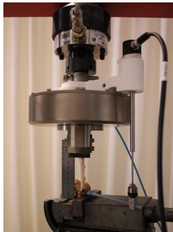
Figura 33. Soporte LVDT posicionado en mordaza
