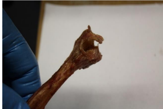
Figura 48. Desprendimiento de túnel espécimen L220006
