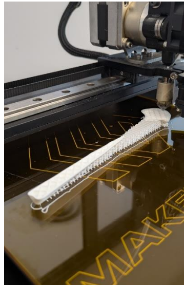
Figura 72. Impresión Peroné 3D con PLA
