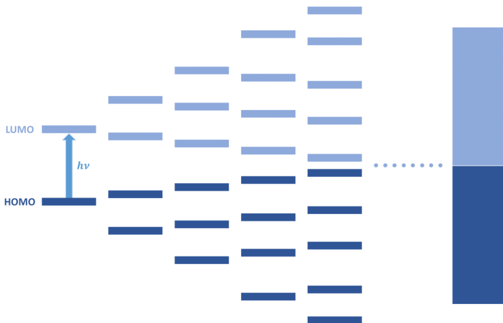
Figura I.8. Evolución esquemática para la energía de los orbitales moleculares de moléculas conjugadas. En el límite de conjugación, los orbitales se describen como bandas de valencia (abajo) y conducción (arriba).
