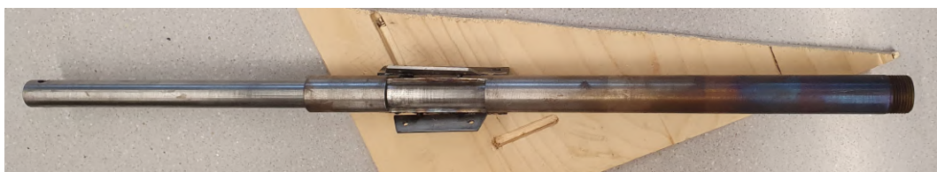
Figura 11: Émbolo bloqueado dentro del tubo de inyección. Fuente Propia
