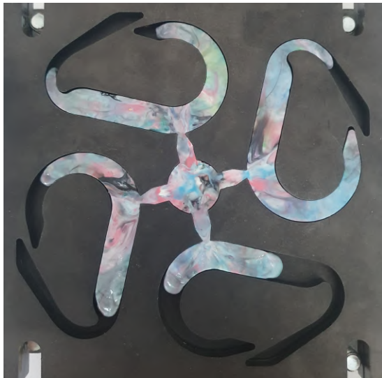
(b) Molde incompleto provocado por una consistencia demasiado poco fluida.
