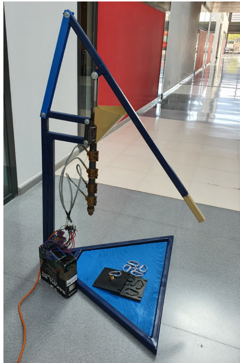
Figura 22: Inyectora una vez pintada siguiendo el código de colores propuesto por MAREA Plastic . Fuente propia.
