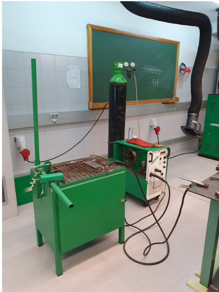
Figura 15: Equipo MIG/MAG usado para soldar la estructura. Fuente propia.
