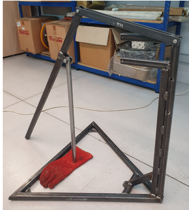
(b) Parte de la estructura tras ser soldada.
