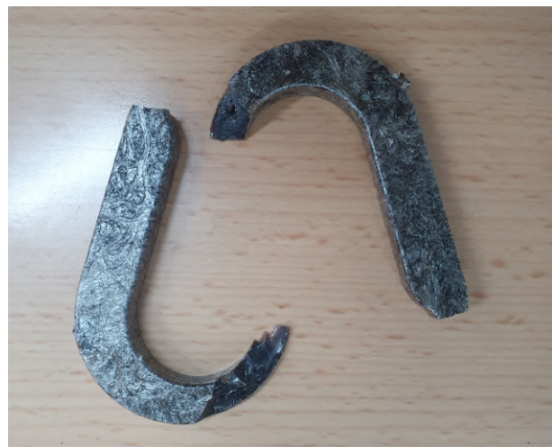
(c) Pieza con material quemado y muy frágil debido a temperaturas demasiado altas.
