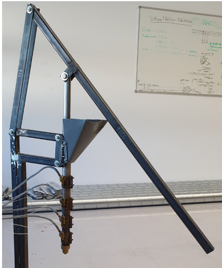
Figura 8: Posición de reposo de la palanca en el diseño inicial. Fuente propia.
