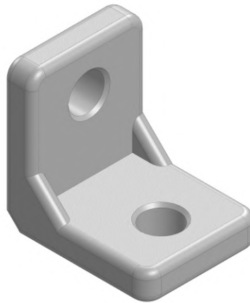
Figura 35: Modelo 3D de la escuadra usada para unir los paneles de metacrilato. Fuente Propia.
