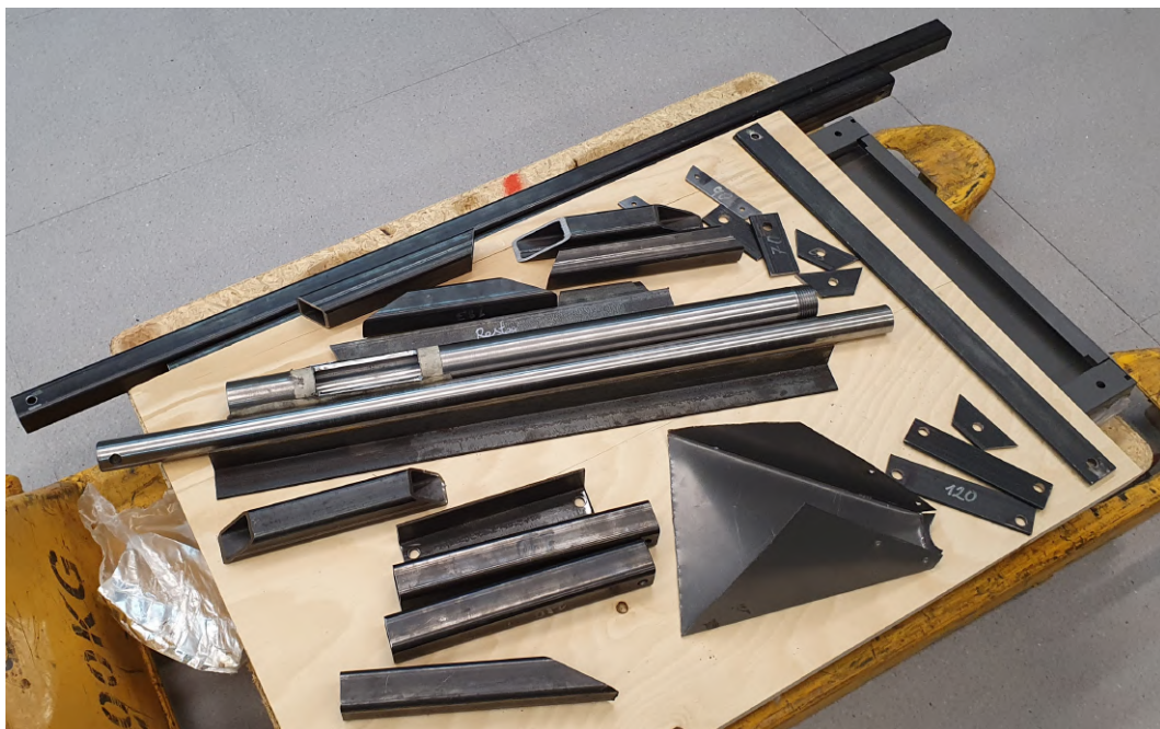
Figura 13: Piezas listas para el proceso de soldadura. Fuente propia.
