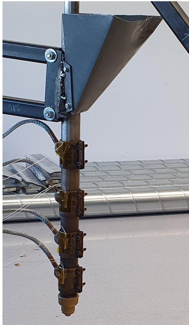
Figura 7: Detalle de la situación original de las resistencias. Fuente propia.
