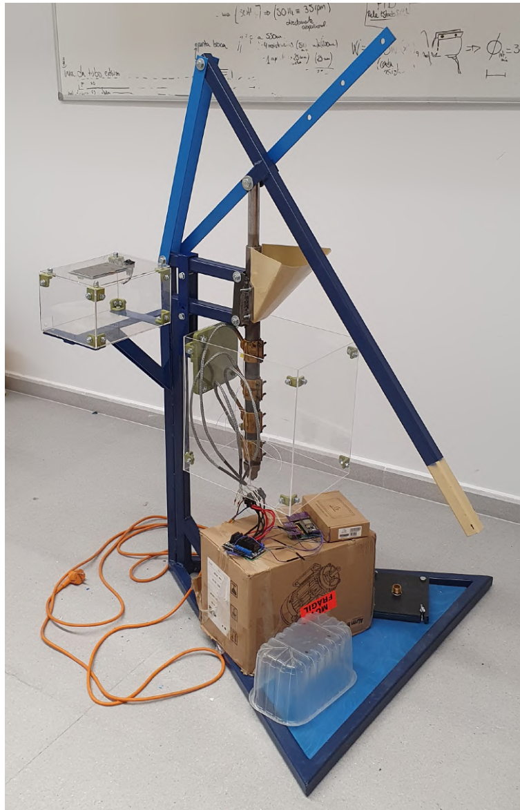
Figura 36: Resultado de añadir el protector del tubo de inyección al prototipo. Fuente Propia.
