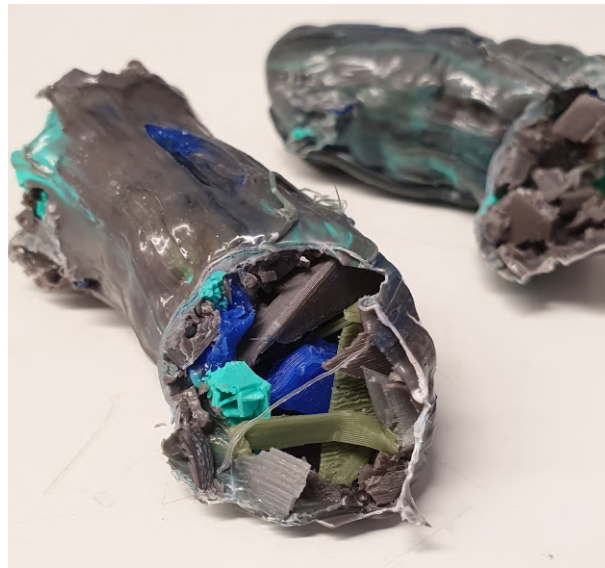
(a) Material no fundido en el centro debido a una temperatura demasiado baja.
