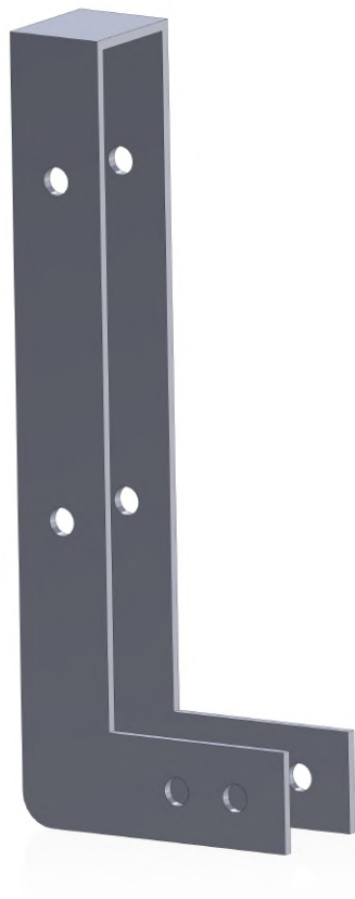
Figura 31: Modelo 3D de la pieza de unión entre la estructura y el protector del tubo de inyección. Fuente Propia.
