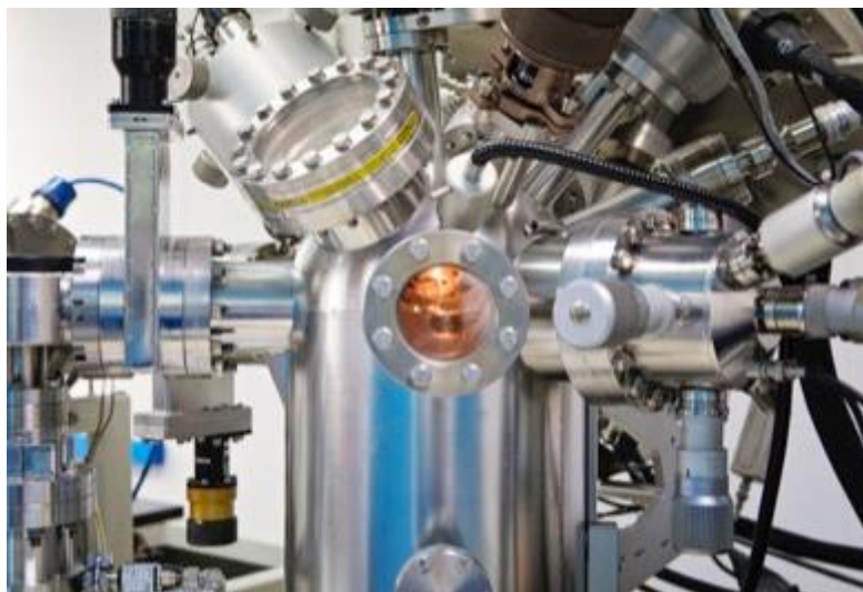
Figure 1.25. Picture of PHI 5700 XPS spectrophotometer used in this thesis, in Servicio Central de Apoyo a la Investigación (SCAI) of Universidad de Málaga .
