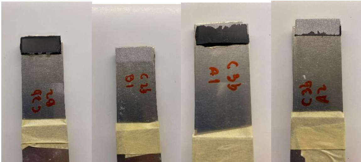
Figura 71. Ejemplo de resultados tras ensayo de tracción en probetas tratadas con corindón.
