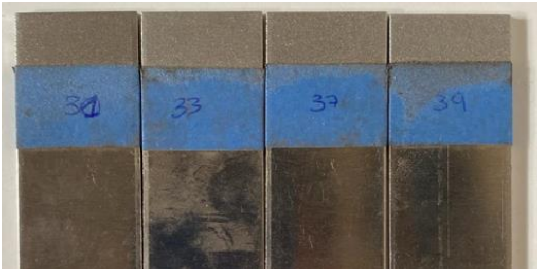
Figura 53. Superficie de las probetas tras el tratamiento de granallado usando corindón a presión 5 bar.
