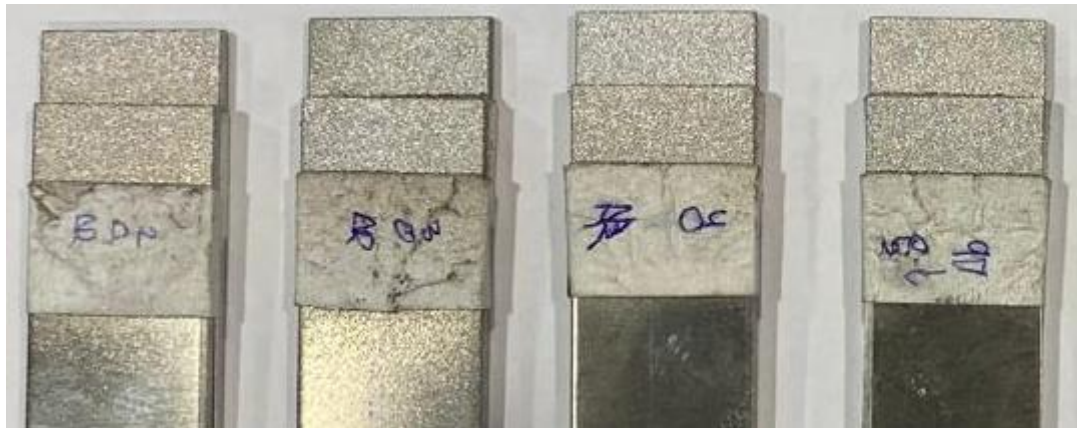
Figura 51. Superficie de las probetas tras el tratamiento de granallado usando esferas de vidrio a presión 5 bar.
