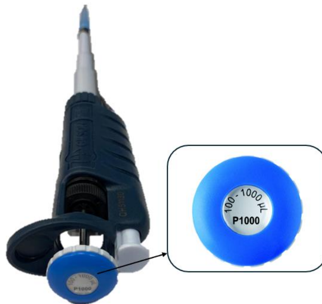
Figura 42. Micropipeta Pipetman Classic usada para la aplicación de la gota en el ensayo sésil.
