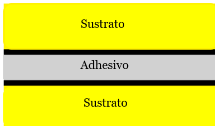
Figura 6. Esquema de la disposición de los diferentes elementos que intervienen en una unión mediante adhesivos (elaboración propia).
