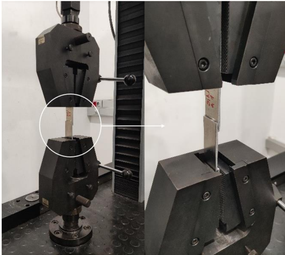
Figura 47. Probeta y elementos de la máquina de tracción durante el proceso de ensayo.
