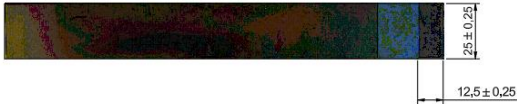
Figura 19. Esquema de medidas del extremo a tratar y zona protegida por cinta de carroceros TESA 4317.
