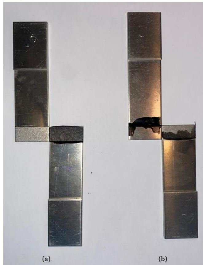
Figura 66. (a) Ejemplo de resultados Fallo cohesivo del adhesivo AF en donde el adhesivo está situado en una sola probeta. (b) Ejemplo de resultados Fallo cohesivo del adhesivo AF en donde el adhesivo está situado en ambas probetas.
