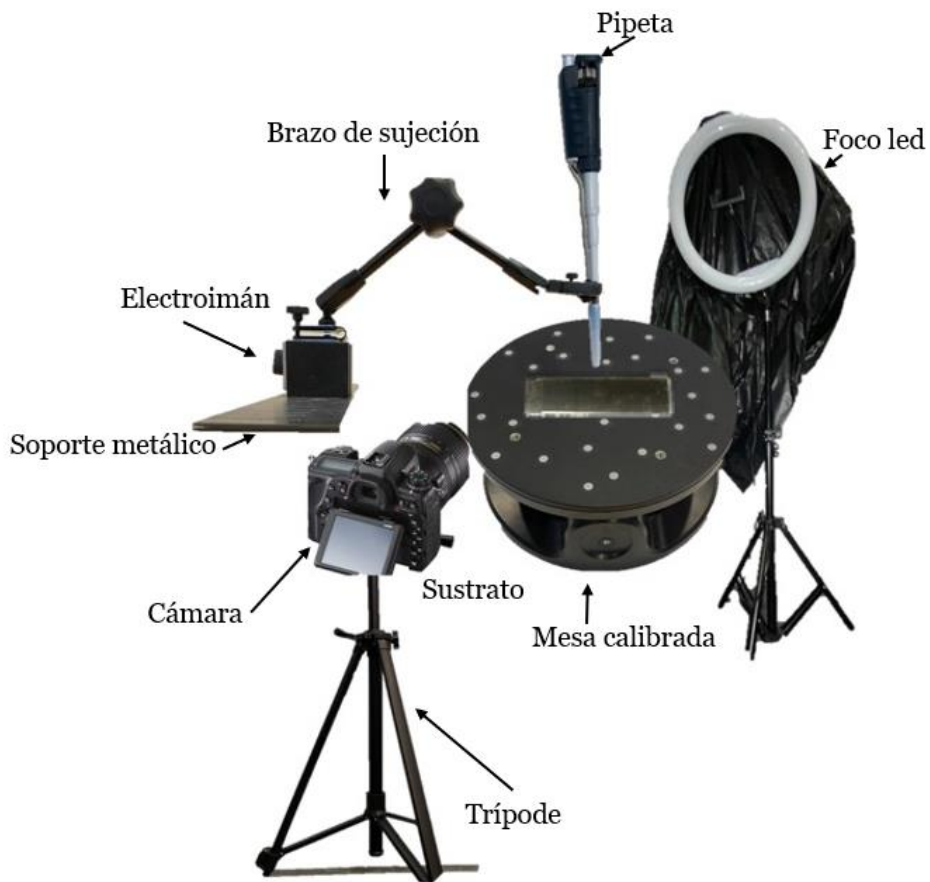
Figura 40. Montaje de los útiles necesarios para el ensayo.
