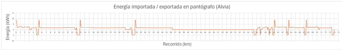
Imagen 30: Gráfica de energía importada/exportada en pantógrafo para tren Alvia
