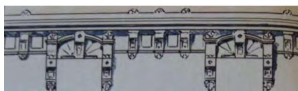
753. Casa en Camino de Antequera. Sobredintel en arco con clave y diseño radial. Discretas palmetas sobresalen de la cornisa, marcando cada ménsula.
