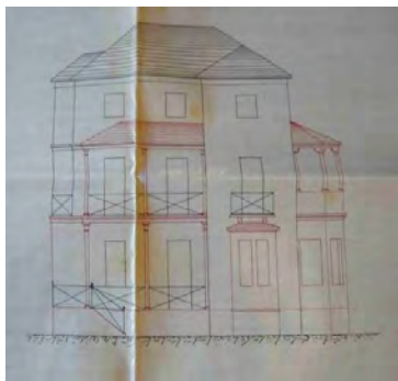
800. Alzado de la fachada principal, orientada al sur. Añadido de porches y miradores.
