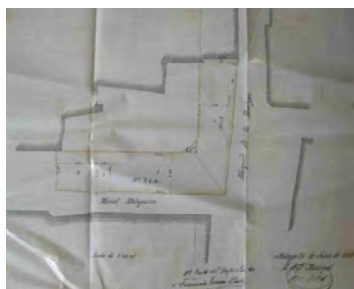
240. Plano con el atirantado de la esquina de la calle Salvago con Compañía. Rivera, junio de 1915.
