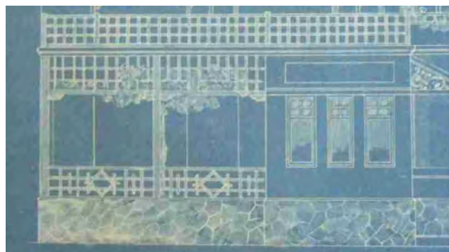
874. Casa en Paseo de Miramar. Detalle de la carpintería geométrica. Ventanas tipo Mackintosh.
