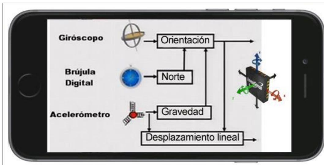
Figura 3.15. Componentes del sistema de detección de movimientos (Fuente: Invensense)
