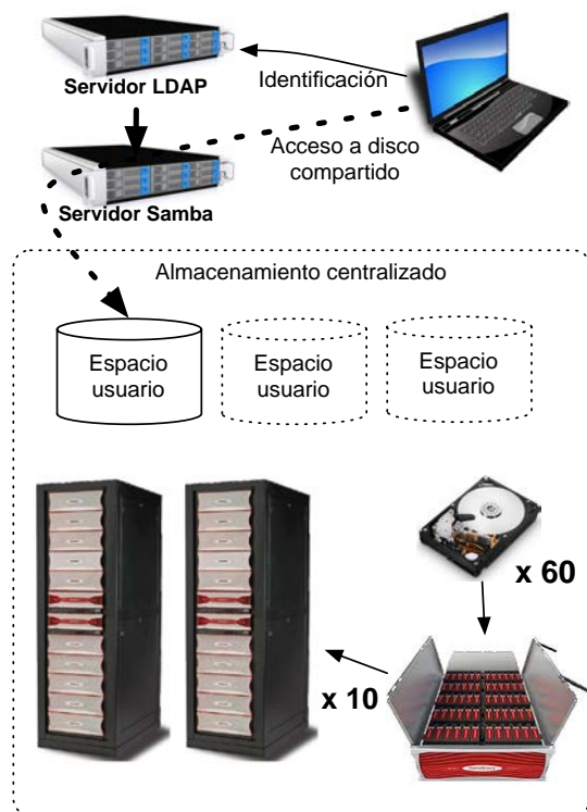
Figura 5.1: Almacenamiento compartido para clientes basado en Samba
