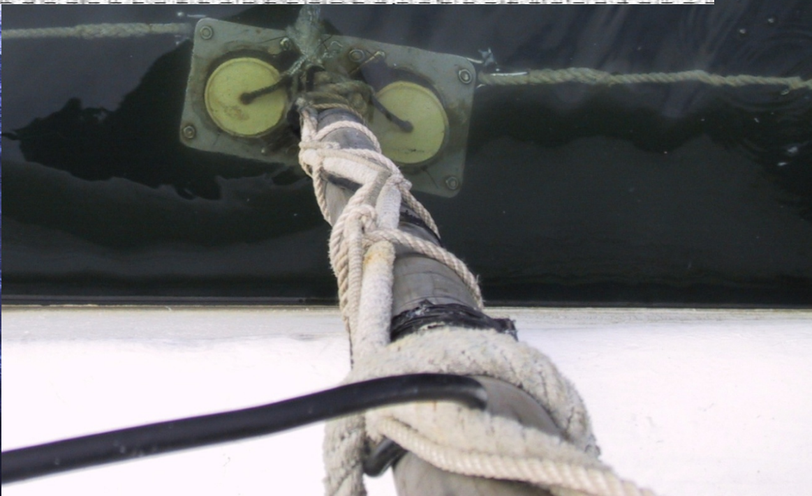
Sensor del 3.5 kHz (dos cerámicas) fijo a la borda
