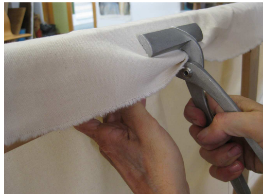
Tensado de la loneta con tenazas
