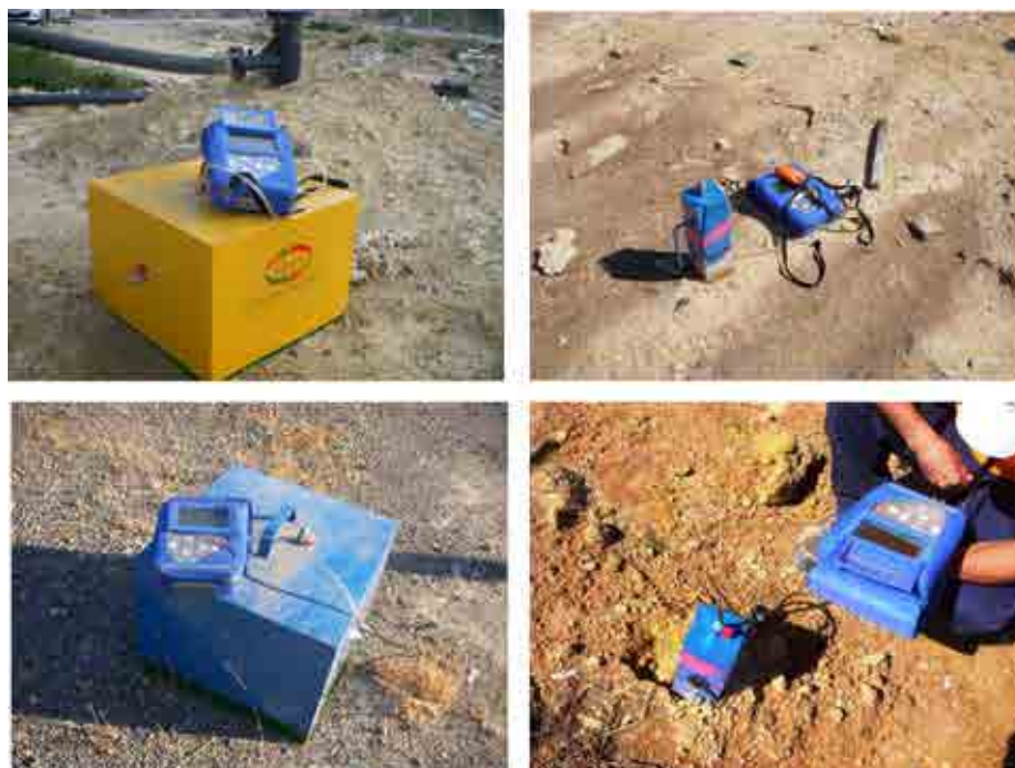
Figura 4.17. Cámaras de flujo estáticas utilizadas durante los muestreos (dos modelos de diferentes dimensiones) y analizador GP 2000.
