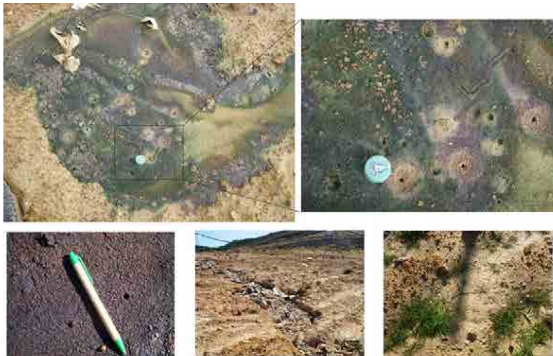
Figura 4.18. El burbujeo es uno de los mecanismos de emisión más claros en zonas sin pendiente y saturadas, la estructura de la capa de sellado pierde competencia y el empuje del gas genera caminos preferenciales que superficialmente se manifiestan mediante burbujas. La generación de cárcavas y de grietas de retracción puede tener similares consecuencias.
