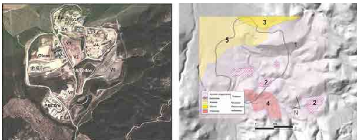
Figura 2.2. Derecha, esquema geológico de la zona ocupada por el Complejo Medio Ambiental de Valsequillo (Antequera). 1. Arcillas abigarradas, margas y yesos triásicos. 2. Dolomías, brechas y carníolas triásicas. 3. Arenas, conglomerados y margas grises terciarias. 4. Glacis formado por calizas y calcarenitas en matriz calcárea del Pleistoceno. 5. Coluvión de arcillas y arenas de igual edad. Izquierda. Instalaciones del Complejo V1 a 5 Vasos de vertido. El vaso 6 se ubica sobre el V1 y V2, no se aprecia en la fotografía por ser esta anterior a su construcción. A. Lodos: Acopio de lodos, Z. Ext: Zonas de extracción de préstamo. P RCD: Planta de tratamiento de Residuos de la Construcción y Demolición. VE: Vertedero de inertes (escombros, rechazo de la anterior). PC: Planta de Clasificación de envases. GE: Equipos de generación de energía a partir del biogás. ZA: Zona de acopios de diferentes tipos de residuos. 2012.
