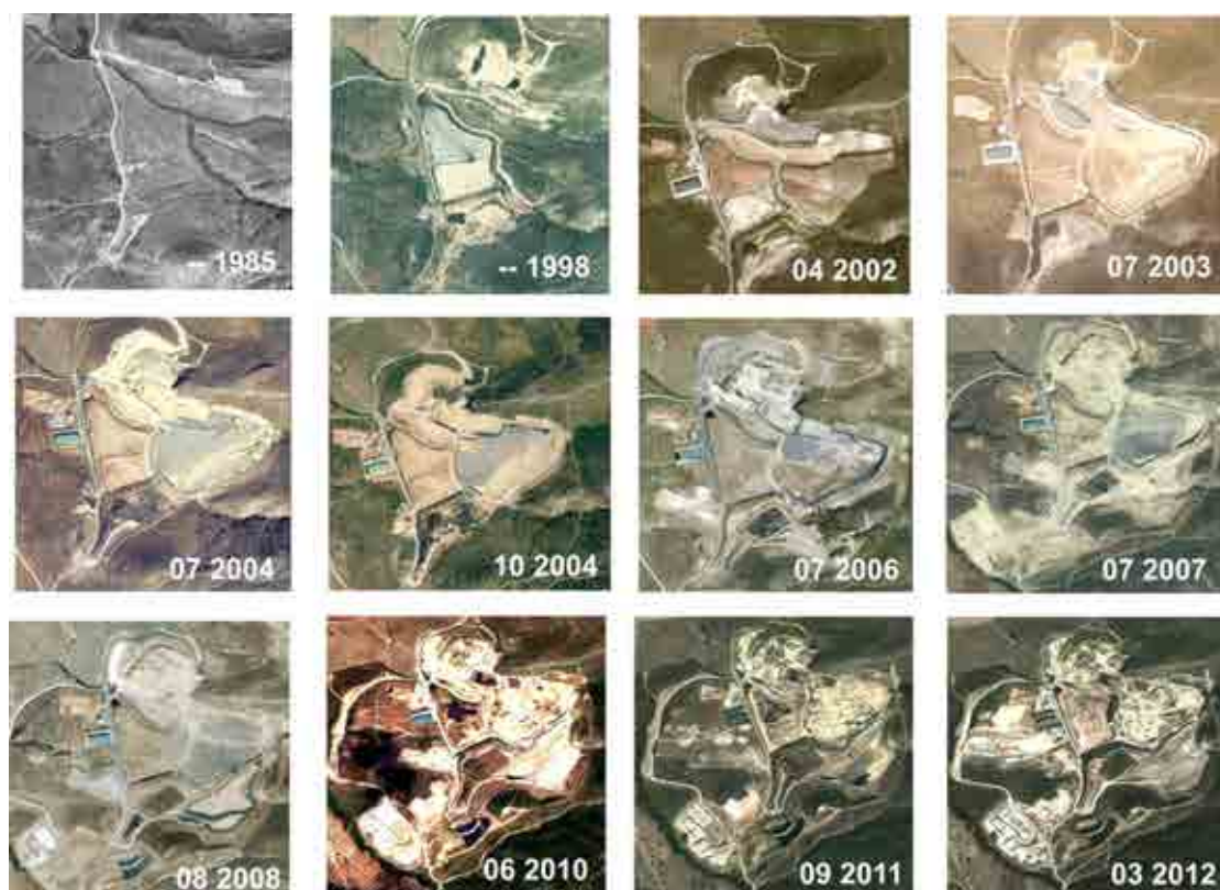
Figura 1.2. Evolución del Complejo Ambiental de Valsequillo (Antequera, Málaga). La parcela se utilizó como muladar ya en 1985. En 1998 se encuentran en explotación los vasos 1 y 2, en 2002 se explota el vaso 3 encontrándose en funcionamiento la Planta de Tratamiento de Envases. Durante 2003 se realiza el movimiento de tierras del vaso 4 cuya explotación se inicia en 2004 y se prolonga hasta 2008. Durante 2007 y 2008 se construye el vaso 5 que se explota hasta 2012 a la vez que se ejecutan los movimientos de tierras para la implantación de la Planta de Compostaje (Fuentes Google Earth, REDIAM Imágenes Raster Andalucía 2004, 1984-1985 y otras, escala aproximada 1:5000).
