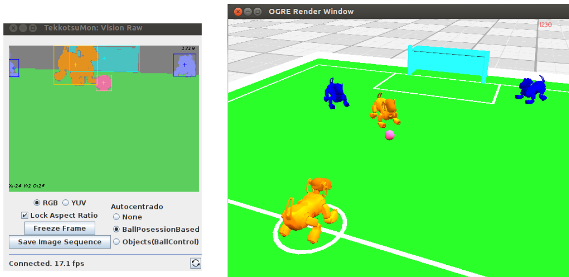
Figura 5.8: Simulador 3D MIRAGE con motor físico Bullets en el entorno Tekkotsu
