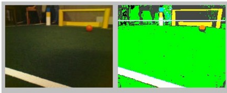
Figura 5.7: Segmentación de imágenes de la cámara de AIBO
