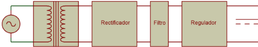
Figura 7 Bloques que componen la fuente de alimentación diseñada
