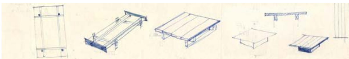
223-IV. El diseño del mueble. Asís Cabrero diseña la totalidad del mobiliario aparejando tablas del mismo modo que el hierro de la estructura, aunque en ocasiones plantea el uso de la madera laminada curvada para construir los brazos de las butacas.
