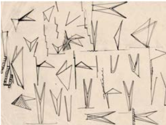
63-III. Dibujos. En los primeros dibujos el autor propone una lámina plegada cuya sección formalice una "V". También en estos dibujos tantea la pirámide abatida sobre el plano vertical.
