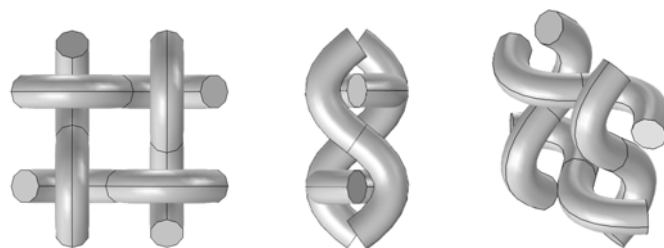
Figura 4.73: Malla de hilo tejido: a. Vista frontal; b. Vista de perfil; c. Vista en perspectiva.
