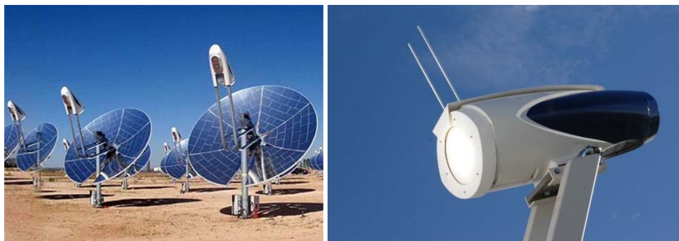
Figura 3.19: a. Sistema Infinia PowerDish 3,2 kW; b. Unidad de Conversión de potencia (PCU).
