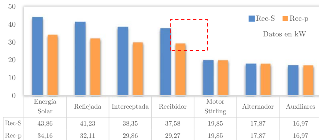
Figura 4.37: Comparación entre absorbedores internos. Flujo de calor a lo largo del sistema a 775 \text{ W/m}^2 para Rec-S y a 600 \text{ W/m}^2 para Rec-p.
