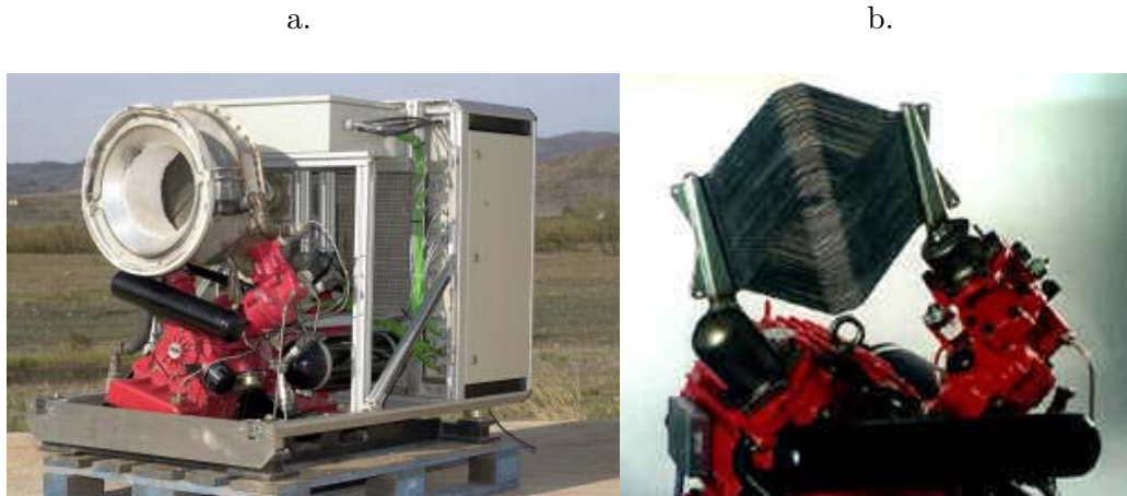
Figura 3.11: a. Conjunto Motor Stirling SOLO V-160 y alternador. b. Detalle del conjunto motor y receptor. Fuente: (Mancini et al., 2003)
